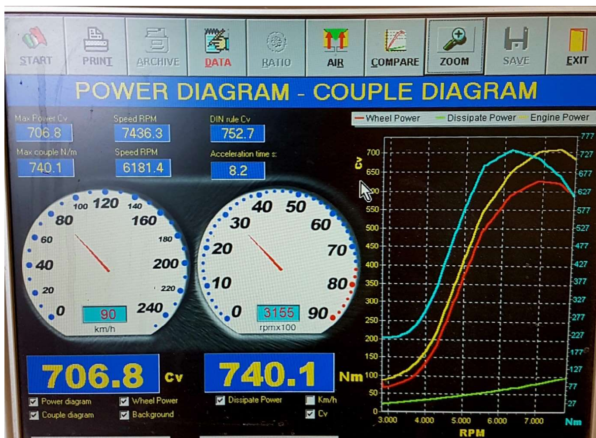
Slika 23. Brzinska karakteristika pri punom opterećenju
