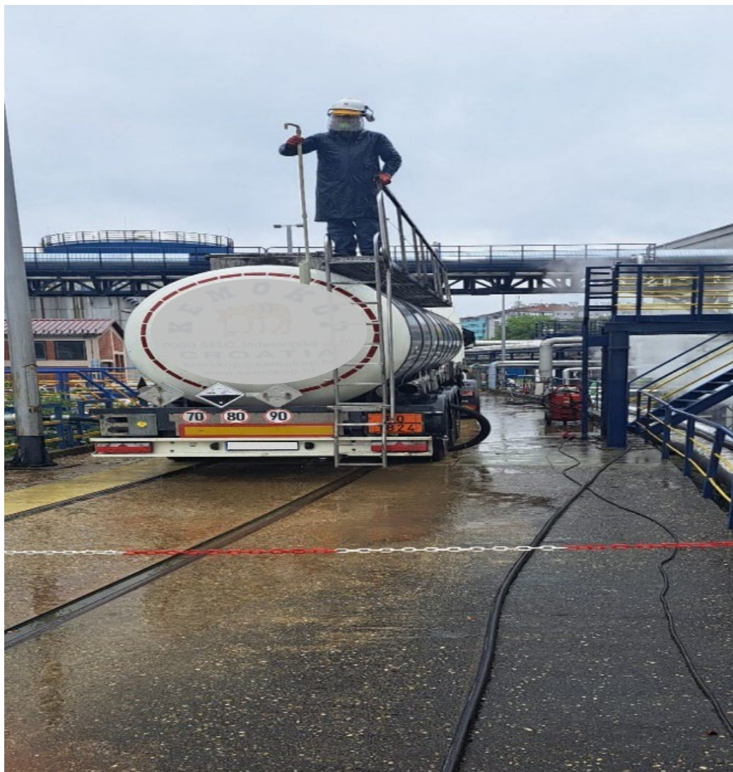
Slika 11. Uzimanje uzorka iz cisterne [17]
