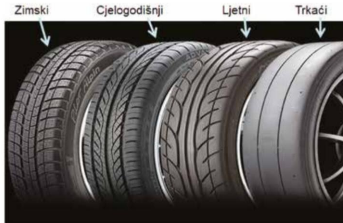
Slika 5. Vrste pneumatika po namjeni [1]
