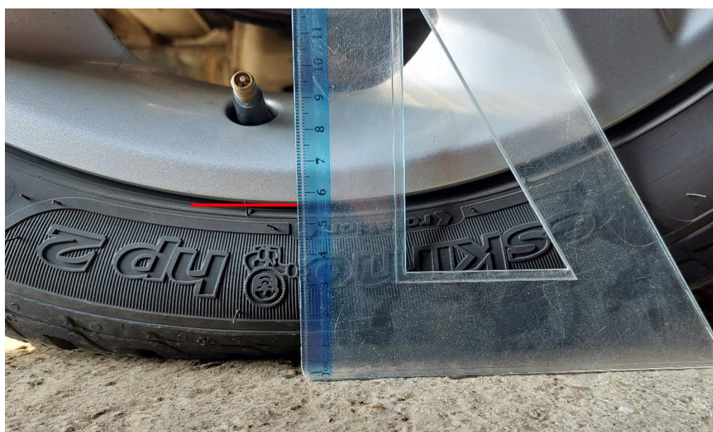
Slika 12. Bočnica gume pri tlaku od 1,9 bara
