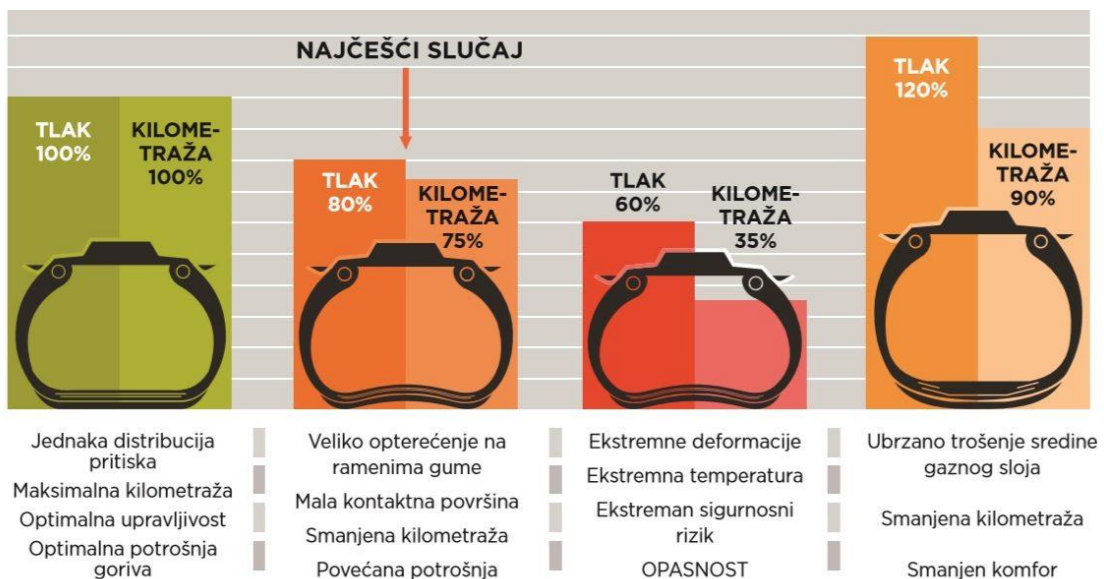
Slika 10. Utjecaj tlaka na gazni sloj i deformaciju gume [5]
