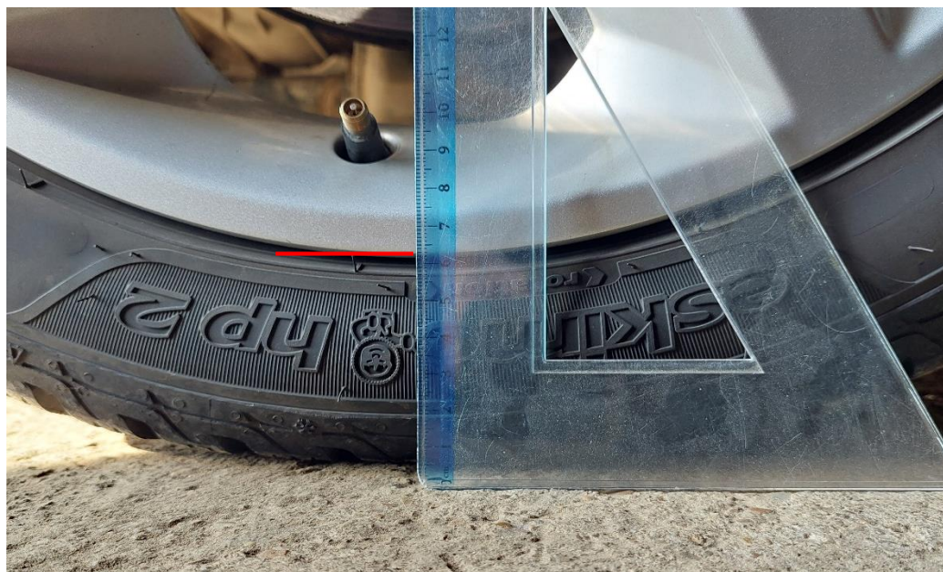
Slika 13. Bočnica gume pri tlaku od 2,7 bara
