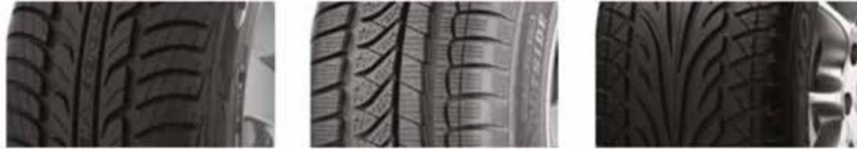
Slika 6. Tipovi profila gazne površine: simetrični, asimetrični, V-oblik [1]
