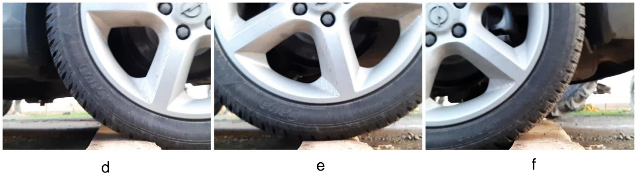
Slika 27. Položaji stražnjeg kotača tijekom prijelaza preko neravnine
