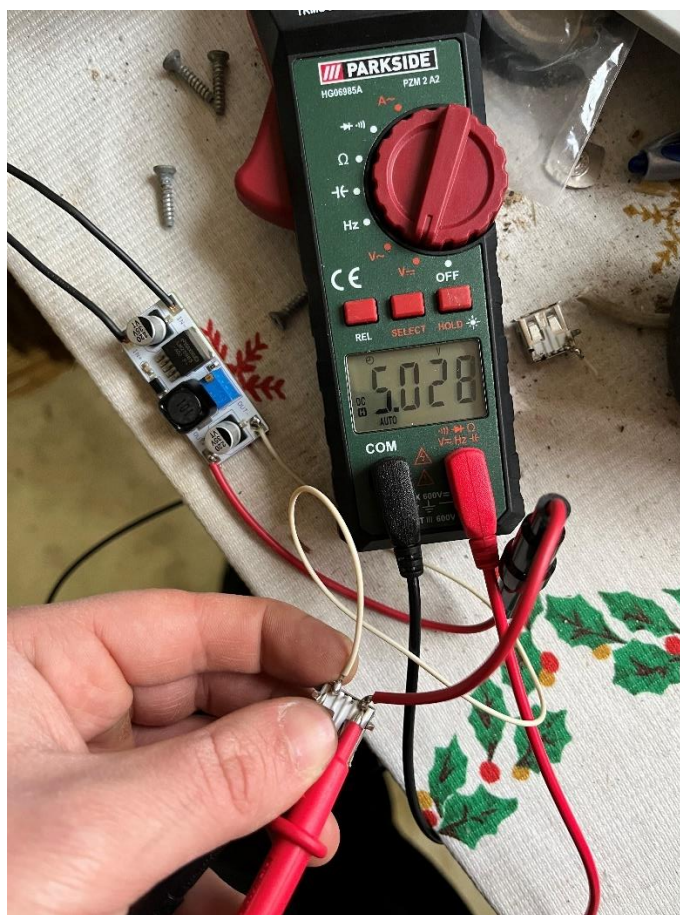
Slika 42: Predodžba izmjerenog izlaznog napona pretvarača. Izvorno autor.
