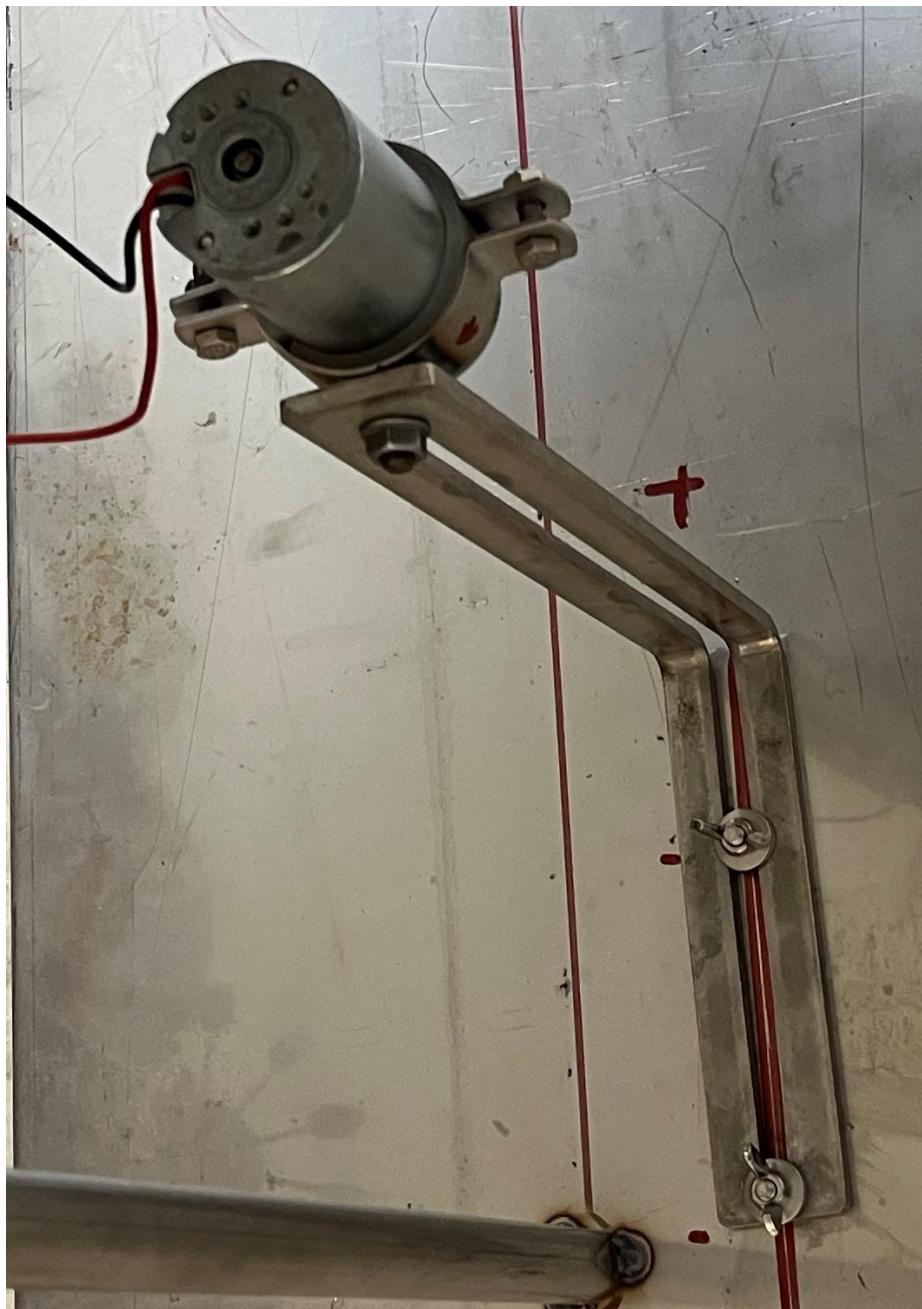
Slika 38: Predodžba nosača motora. Izvorno autor.
