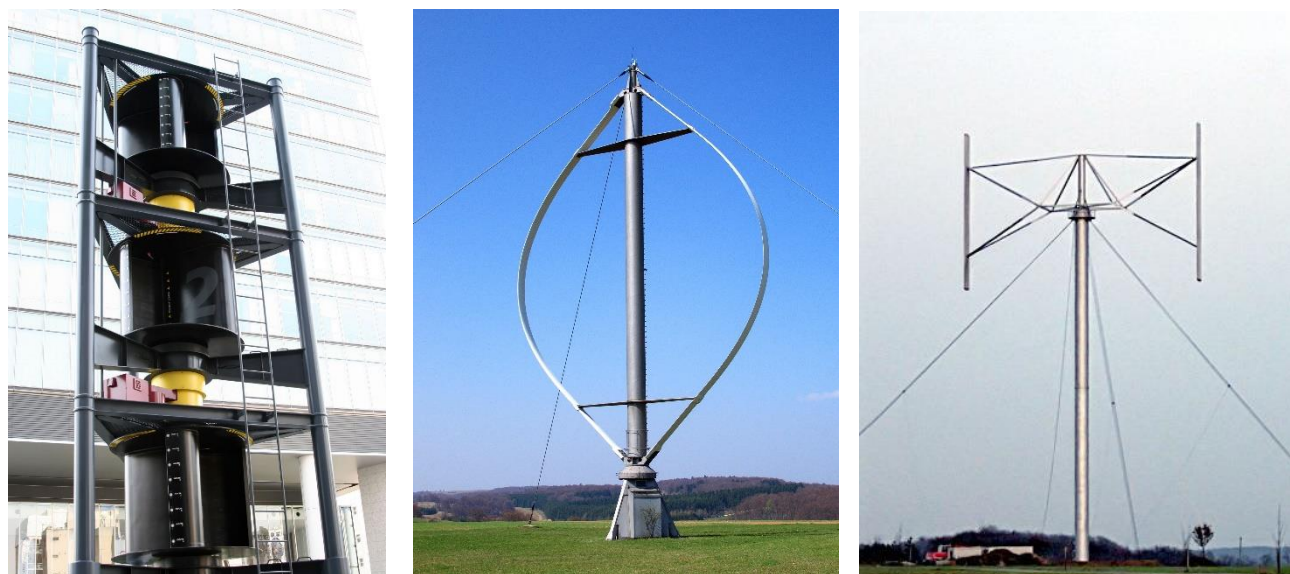
Slika 6: Predodžba Savonius, Darrieus i Giromill turbine (s lijeva na desno)
