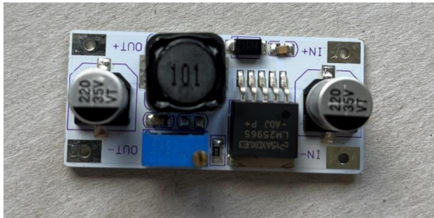
Slika 39: Predodžba pretvarača napona LM2596. Izvorno autor.
