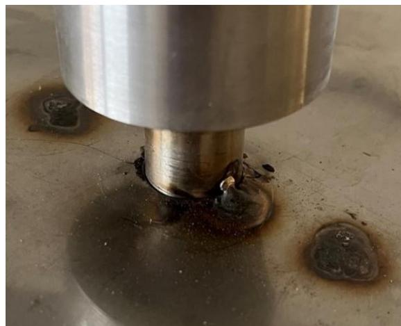
Slika 22: Predodžba zavara osovine za lim. Izvorno autor.
