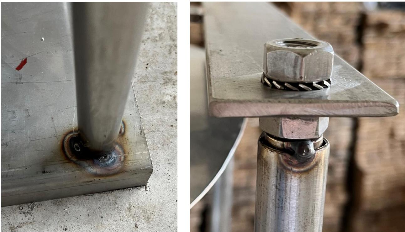
Slika 32: Predodžba spojeva cijevi na postolju i na gornjem učvršćenju. Izvorno autor.
