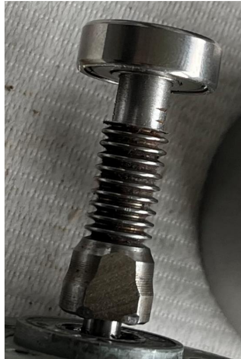
Slika 29: Nacrt obrade remenice i predodžba remenice motora s ležajem na osovini
