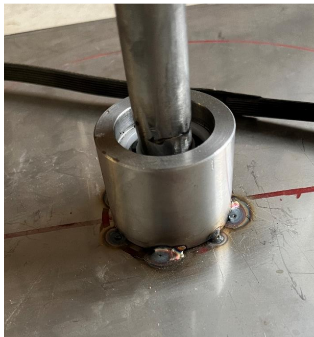
Slika 37: Predodžba pripreme s ležajem. Izvorno autor.
