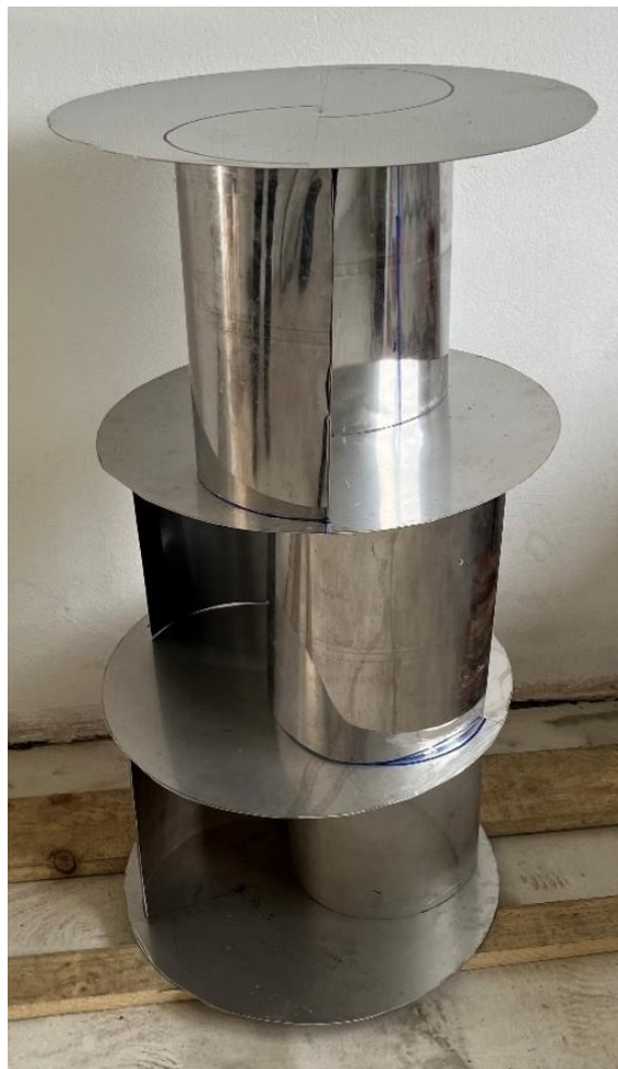
Slika 20: Predodžba posložene turbine prije varenja. Izvorno autor.
