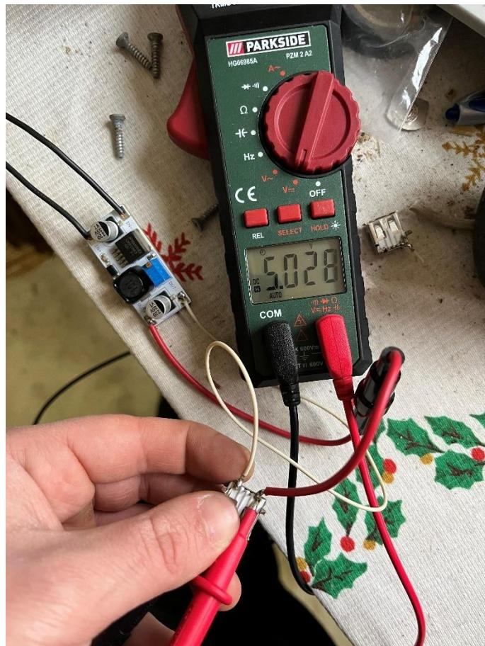
Slika 42: Predodžba izmјerenog izlaznog napona pretvarača. Izvorno autor.
