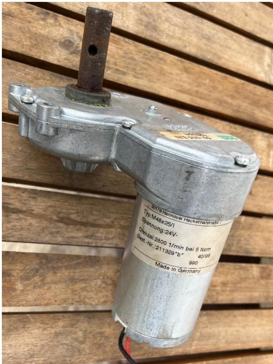
Slika 24: Predodžba motora sa reduktorom. Izvorno autor.
