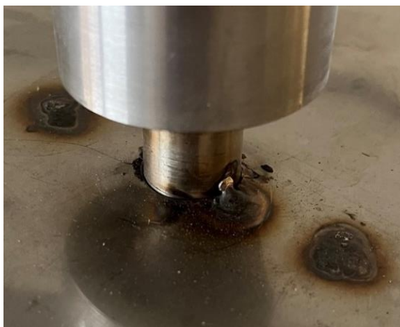
Slika 22: Predodžba zavara osovine za lim. Izvorno autor.
