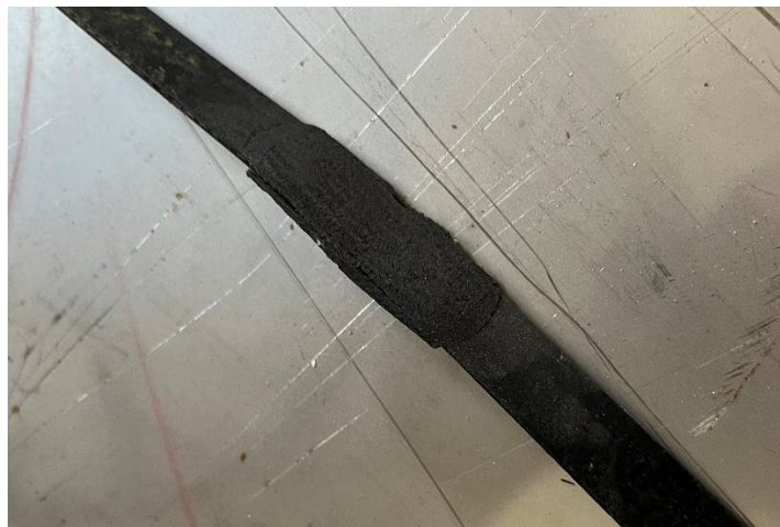
Slika 30: Predodžba vulkanizacije remena. Izvorno autor.
