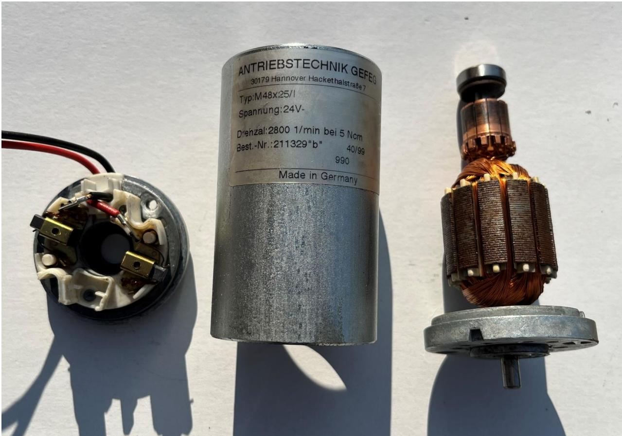
Slika 25: Predodžba rastavljenog motora. Izvorno autor.
