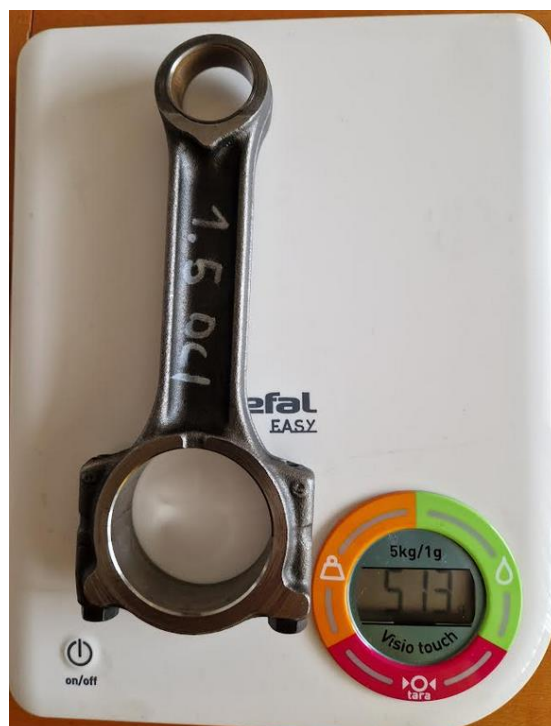
Slika 54. Vaganje ojnice (klipnjače)
