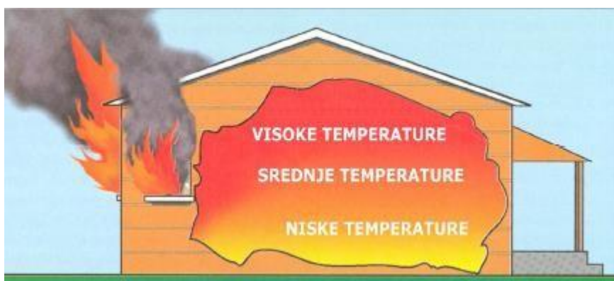
Slika 3.1 Odnos temperature pri požaru zatvorenog prostora Izvor: [3]
