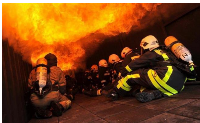
SLIKA 5.4.1. FLASHOVER U SIMULATORU NA KRUTA GORIVA [6]
