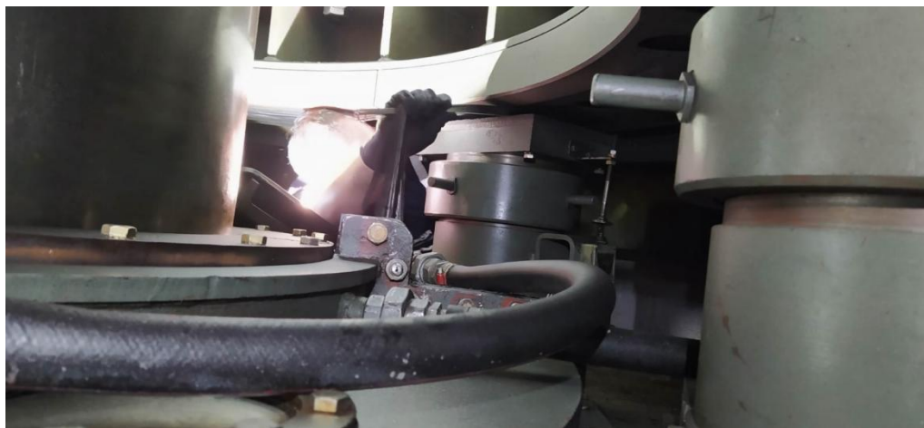
Slika 10: Mjerenje zračnosti pomoću instrumentalnog lima
