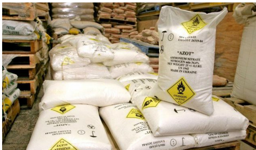
Slika 7.:Skladištenje amonijevog nitrata u zatvorenom prostoru [20].
