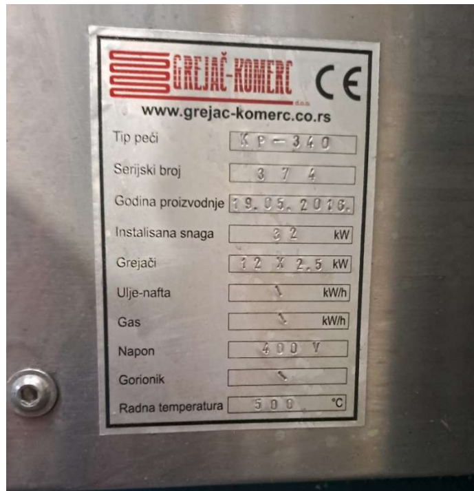
Slika 2. Karakteristike električne peći (izvorno autor)
