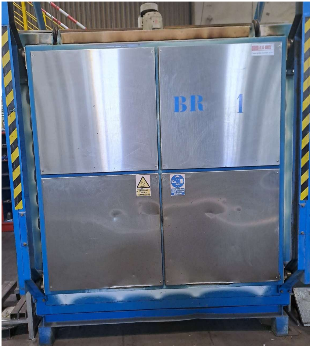
Slika 1. Električna peć za grijanje alata (izvorno autor)
