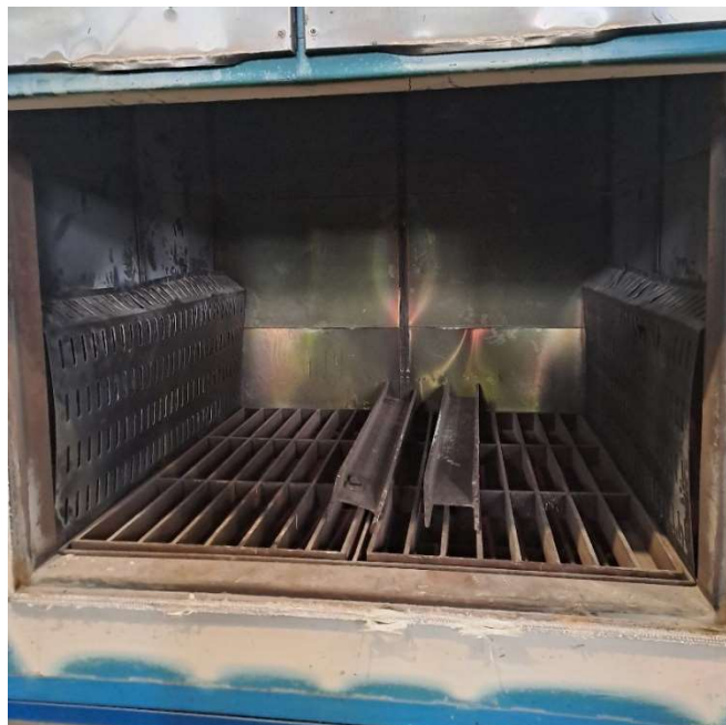
Slika 3. Unutrašnjost električne peći (izvorno autor)
