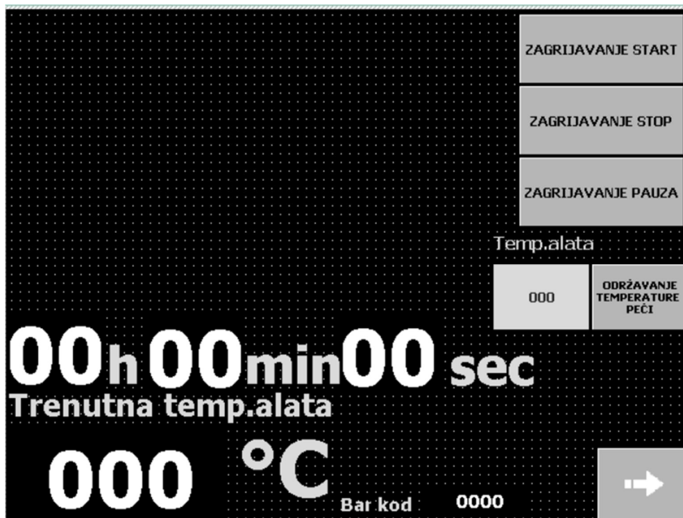
Slika 34. Automatsko upravljanje električne peći (izvorno autor)
