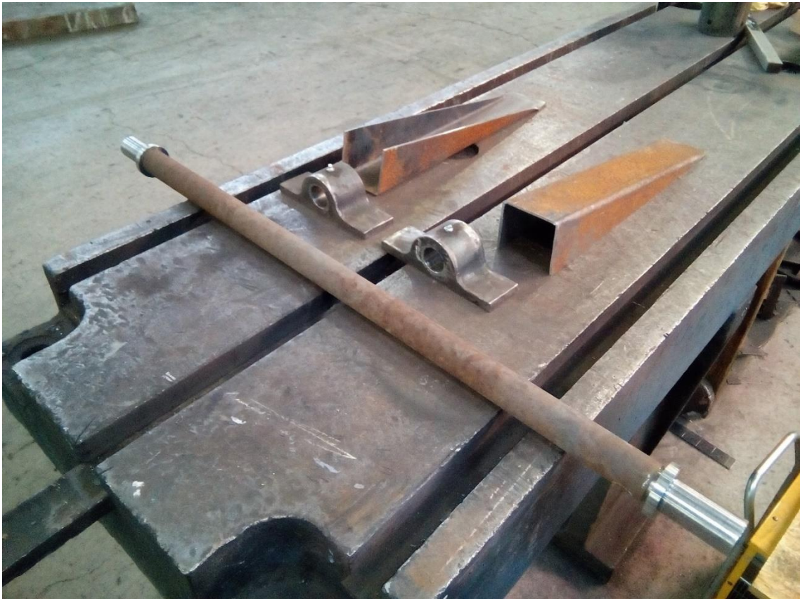
Slika 38. Izrada osovine, kućišta osovine i odbojnika
