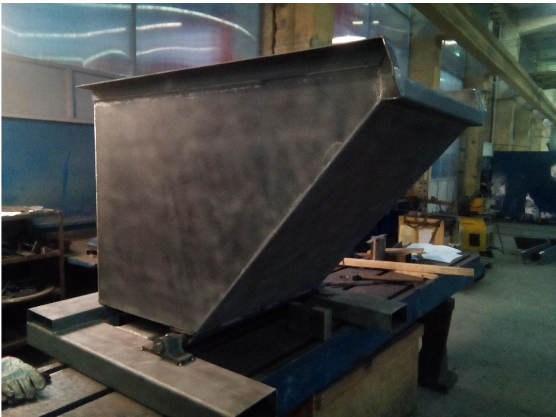
Slika 43. Zavarivanje kućišta osovine za postolje kontejnera
