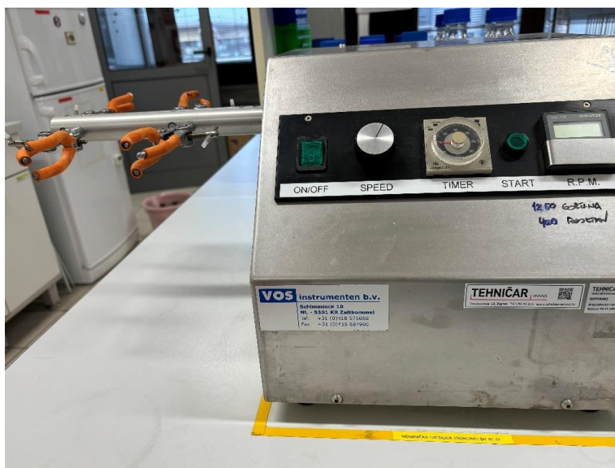
Slika 11. Mehanička mješalica (autor Ivana Šeketa).
