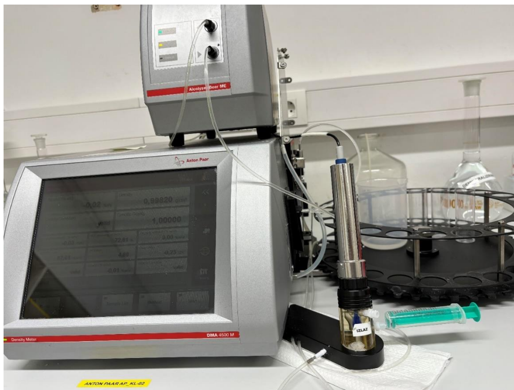
Slika 3. Modularni uređaj za analizu alkoholnih pića Anton Paar DMA 4500 M (autor Ivana Šeketa).
