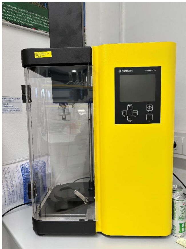
Slika 6. Uređaj za mjerenje TPO i CO 2 (autor Ivana Šeketa).
