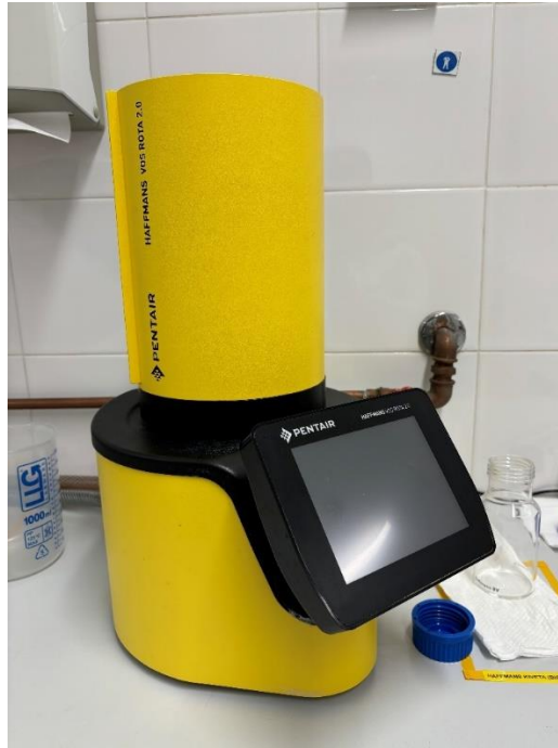
Slika 5. Turbidimetar (autor Ivana Šeketa).
