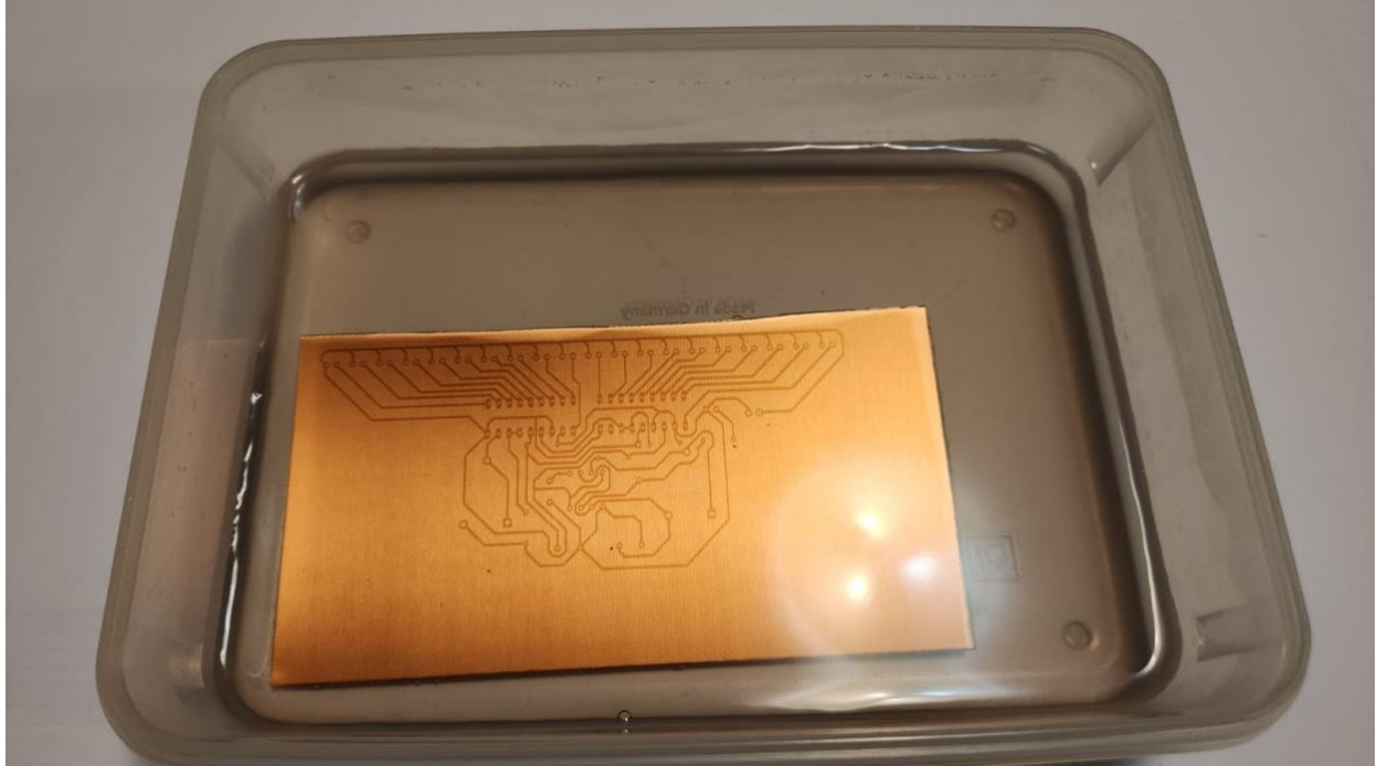
Slika 44. Postupno pojavljivanje obrisa usred kemijske reakcije
