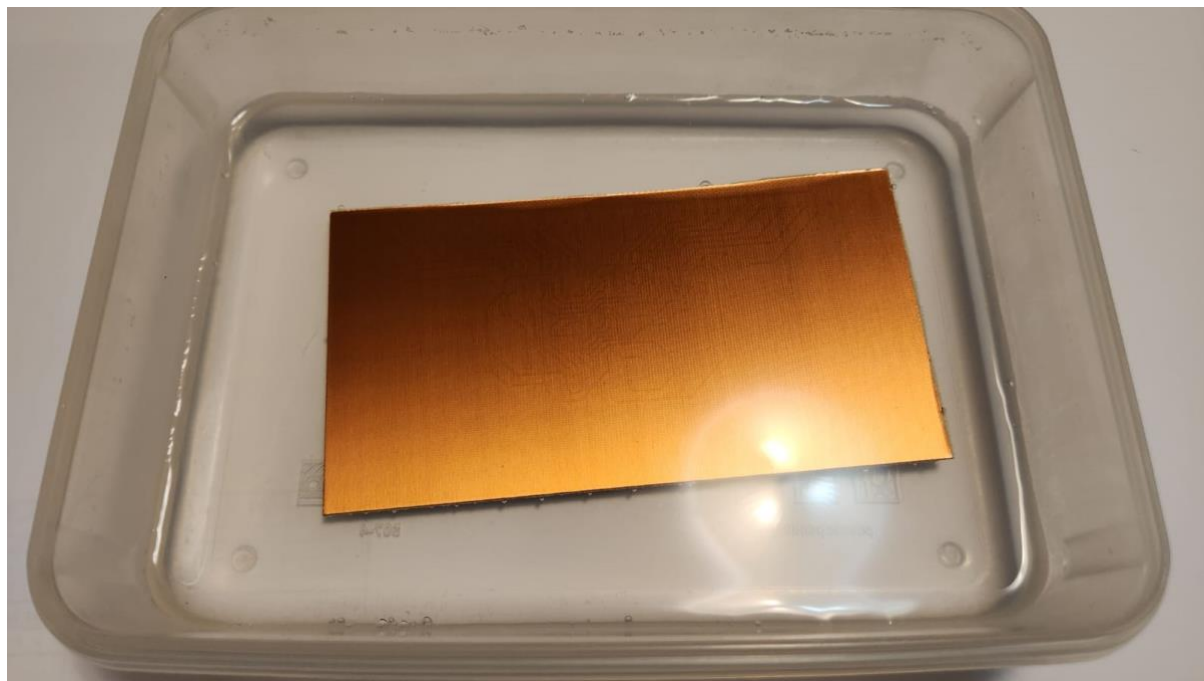
Slika 43. Pločica pokrivena otopinom natrijevog hidroksida za razvijanje
