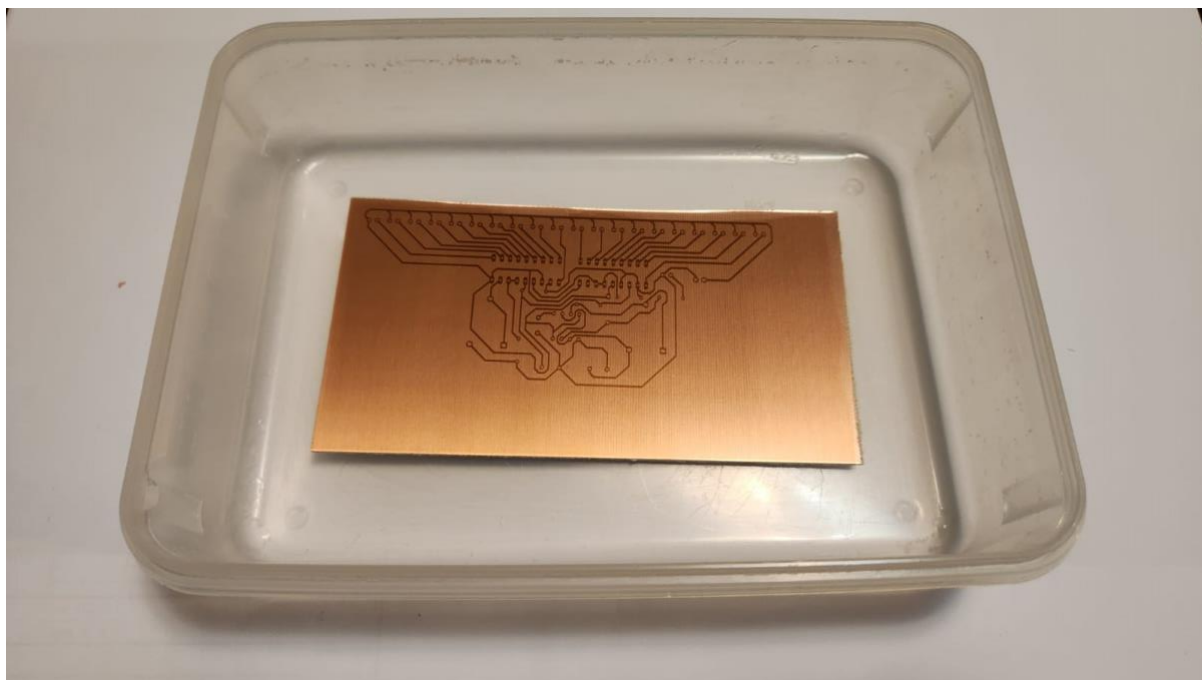
Slika 52. Tiskana pločica s otiskom prije postupka jetkanja
