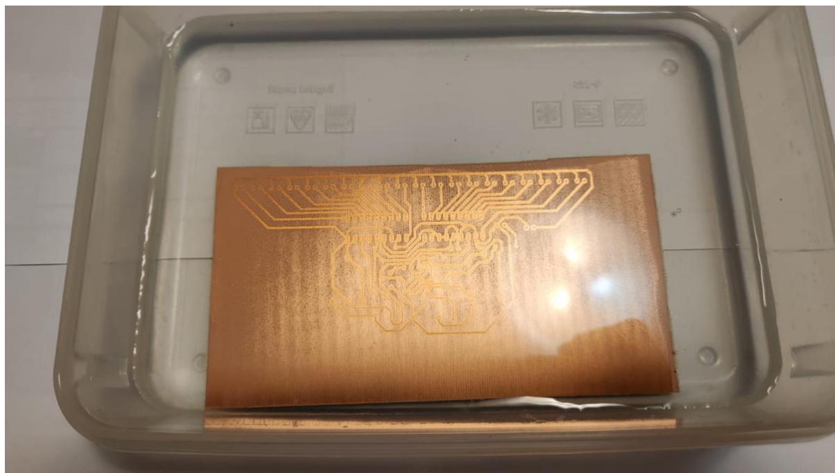
Slika 54. Tiskana pločica u tijeku postupka jetkanja
