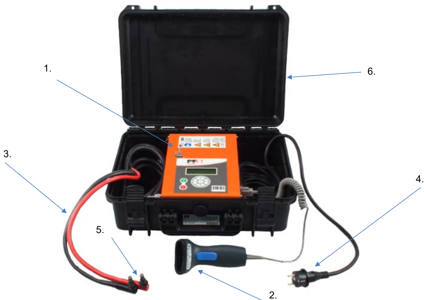
Slika 19. Oprema za elektrofuzijsko zavarivanje [16]
