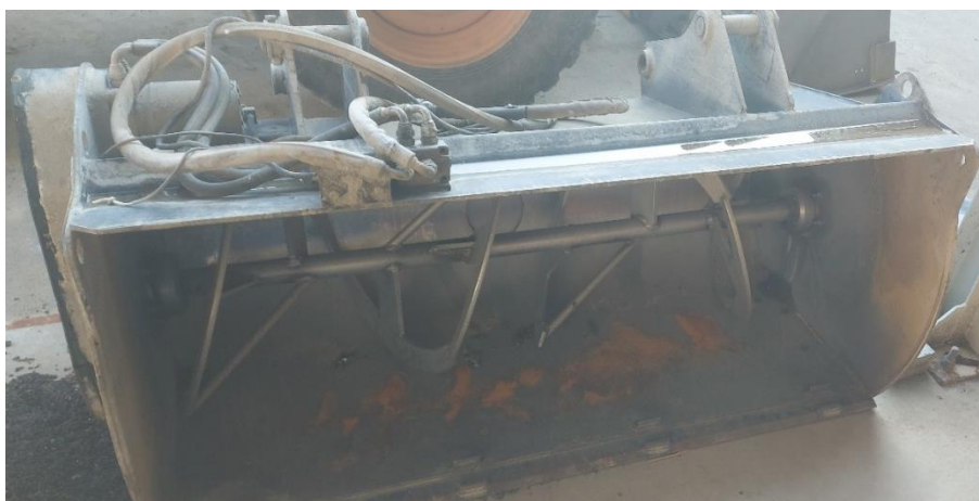
Slika 21. Korpa za beton
