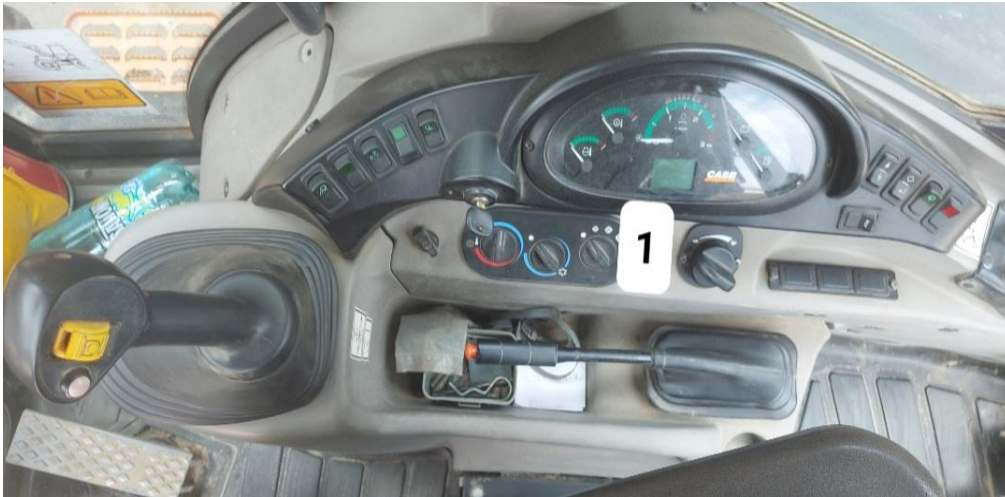
Slika 13. Prekidači za upravljanje prednjom i zadnjom korpom
