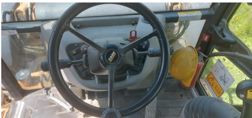
Slika 11. Upravljački dio bagera
