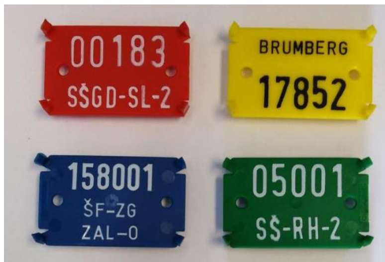
Slika 19. Primjer identifikacijskih pločica koje se stavljaju na čelo trupca [16]
