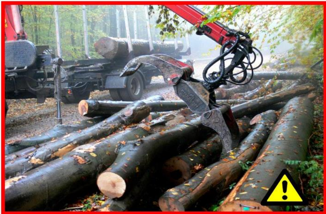
Slika 16. Izvlačenje sortimenta iz hrpe [13]
