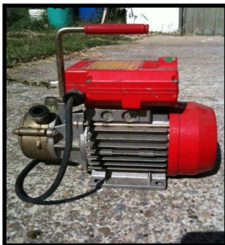
Sl. br. 17 Pumpa za pretakanje vina
