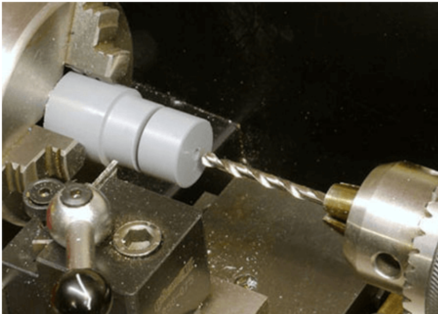
Slika 12 Prikaz bušenja polimernog materijala[13]
