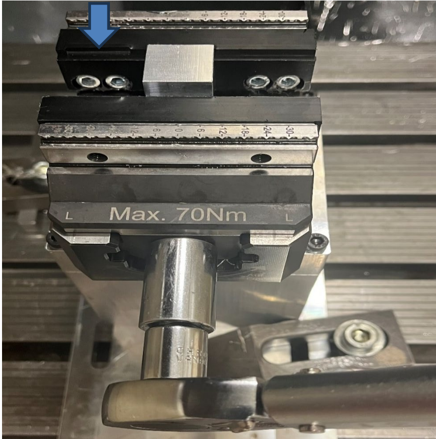
Slika 33. Prikaz deformacije kod stezanja Polietilena - PE
