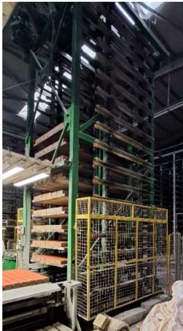
Slika 19. Podizanje betonskih elemenata na transporter za sušaru
