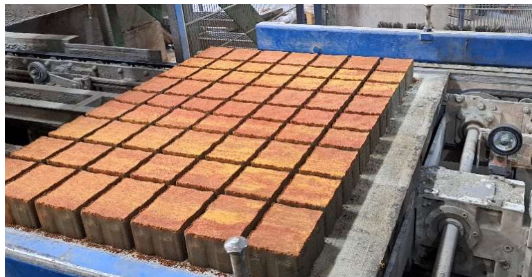
Slika 18. Zbijeni i obojani betonski elementi
