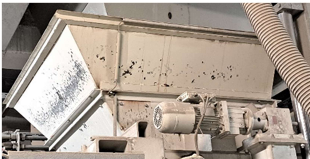
Slika 11. Prihvatni spremnik na stroju za proizvodnju betonskih elemenata
