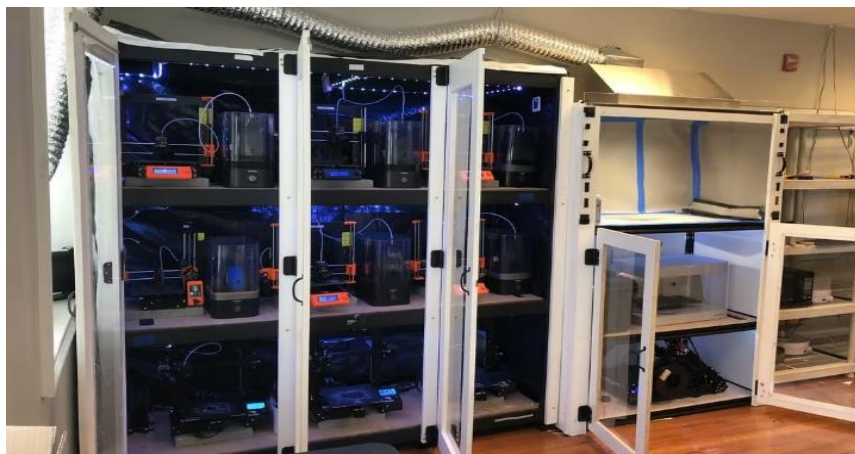
Slika 15. Smanjenje štetnog utjecaja aerosola ventilacijom. [32]
