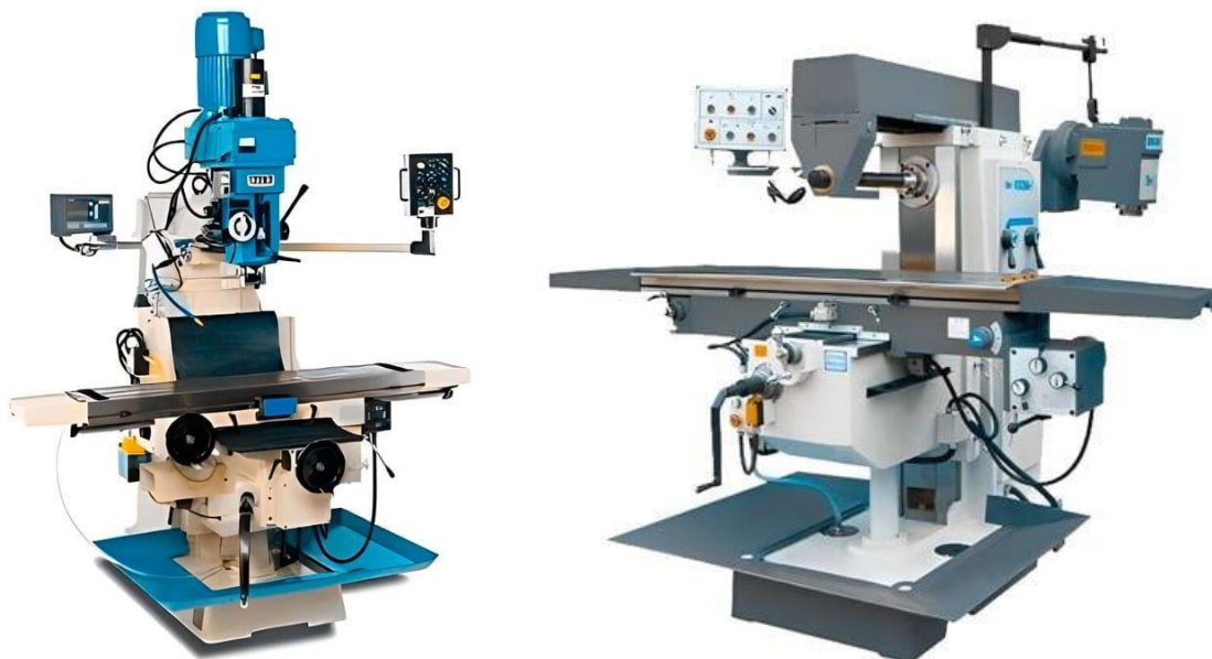
Slika 4. Vertikalna i horizontalna glodalica
