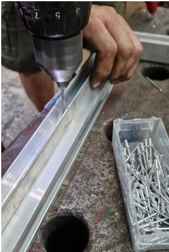
Slika 8. Bušenje provrta za zakovice
