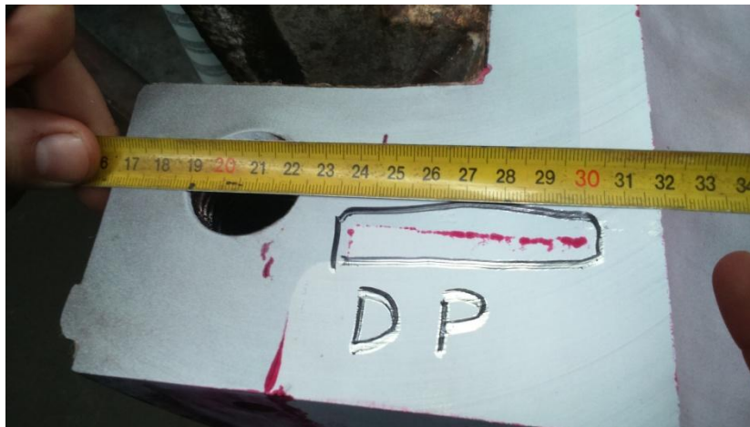
Slika 80a i 80b: Neprihvatljive greške na gornjoj (a) i donjoj (b) polovici ležaja
