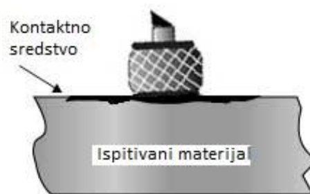
Slika 39: Kontaktno sredstvo kod ispitivanja kontaktnim sondama
