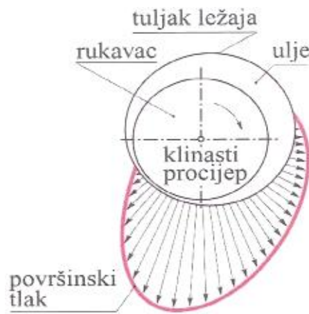
Slika 55: Razdioba površinskog tlaka na blazinicu
