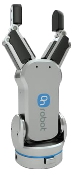
Slika 14. Robot griper. Izvor: OnRobot.com
