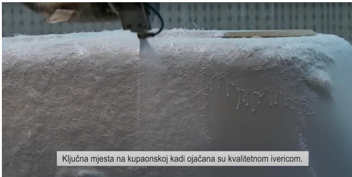
Slika 19. Nanošenje sloja ojačanja. Izvor: Aquaestil.hr
