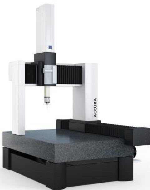
Slika 9. 3 koordinatni mjerni uređaj ZEISS accura
