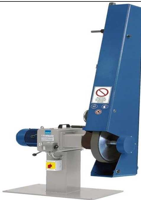
Slika 6. Stroj za ručno poliranje lopatice
