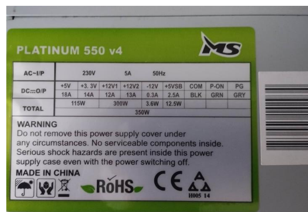
Slika 14. Predodžba tehničkih podataka PC napajanja. Izvor [Autor].
