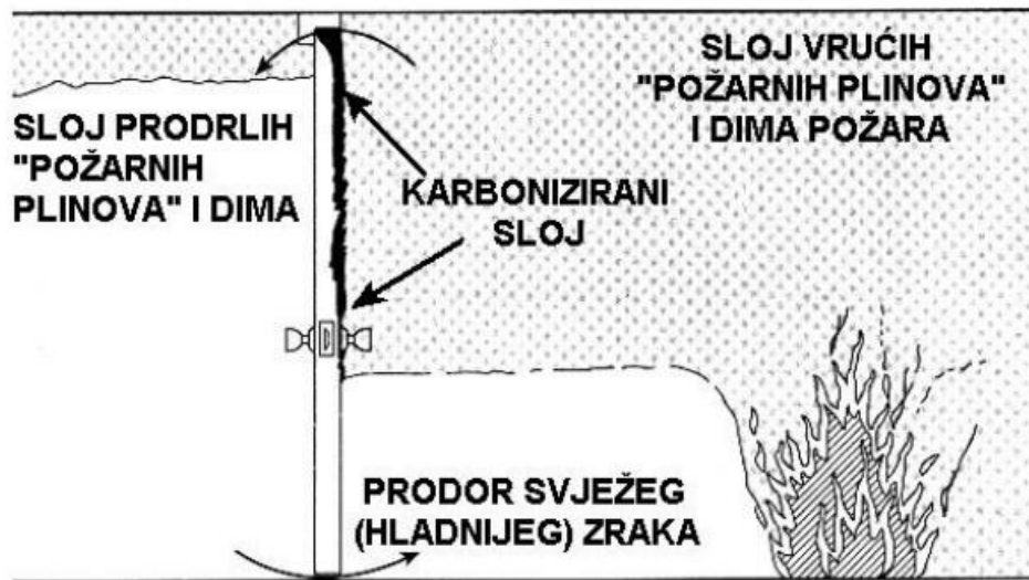
Slika 22. Pojava tragova karbonizacije iz smjera požara [24]
