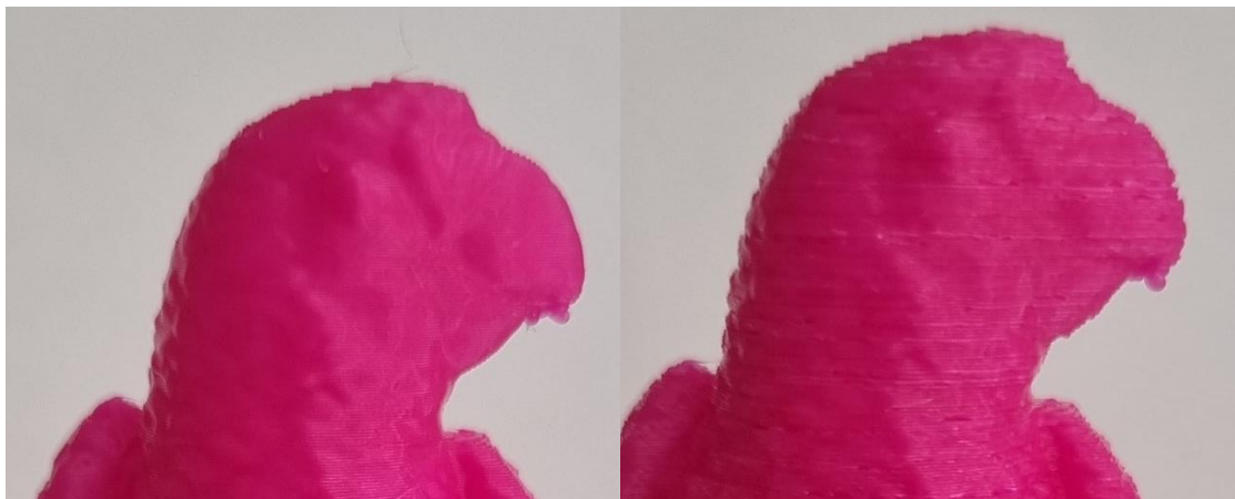
Slika 38 Prikaz razlike uzorka, a) uzorak ispisan na 205°C, b) uzorak ispisan na 250°C
