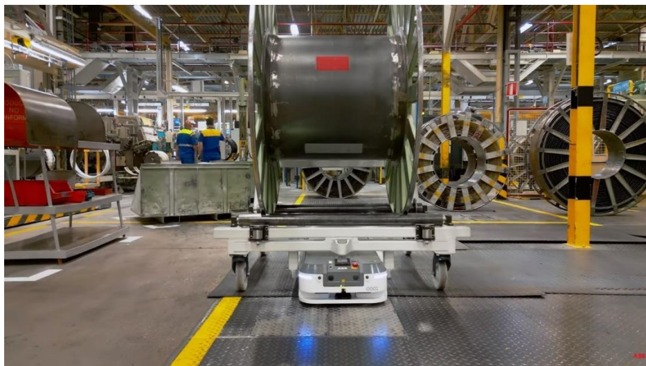
Slika 5. Predodžba AMR-a u tvornici guma Michelin
