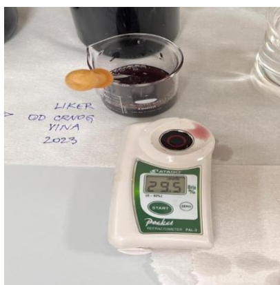
Slika 14 Digitalni refraktometar (vlasita fotografija)
