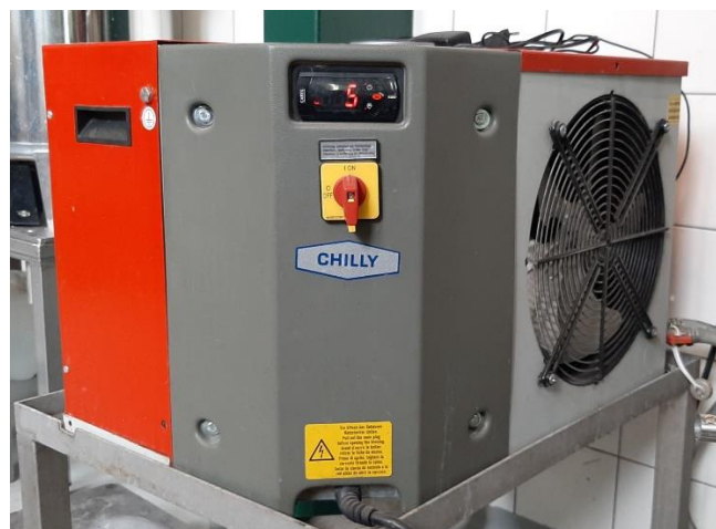
Slika 8. Quantor rashladni uređaj za hlađenje fermentora (izvor: vlastita fotografija)
