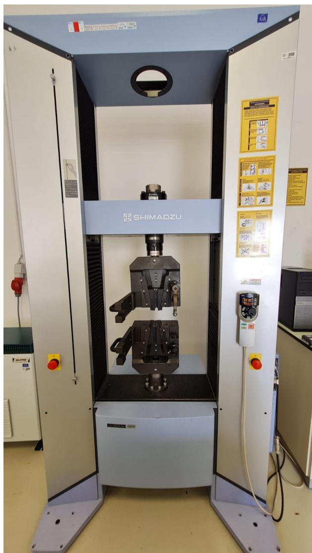
Slika 18. Kidalica SHIMADZU AG-X
