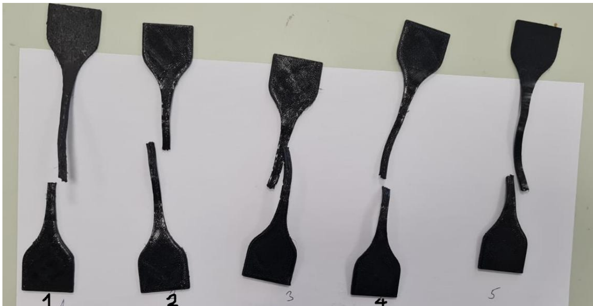
Slika 37. Epruvete od TPU 70A nakon provedenog ispitivanja
