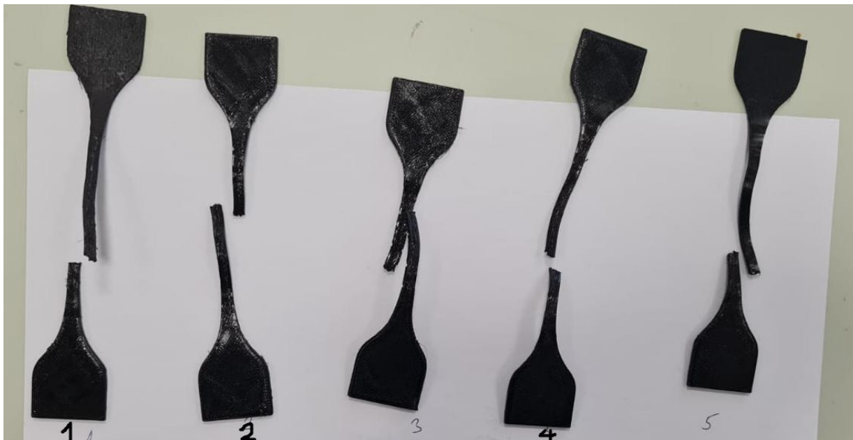
Slika 37. Epruvete od TPU 70A nakon provedenog ispitivanja
