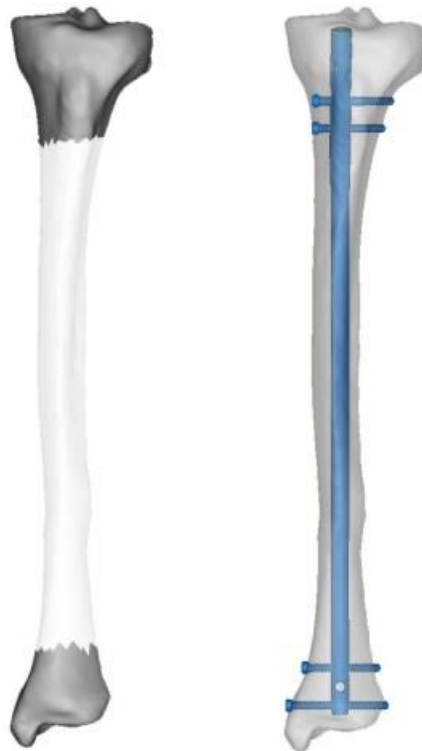
Slika 11. Statički ili dinamički postavljeni vijci bez postavljenih proksimalnih vijaka [3]
