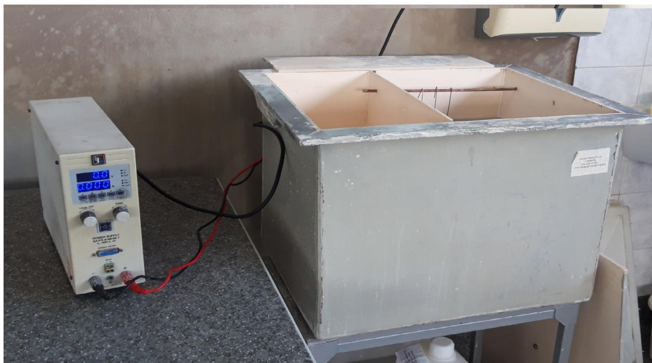
Slika 29. Ispravljač i kadica s elektrolitom [9]
