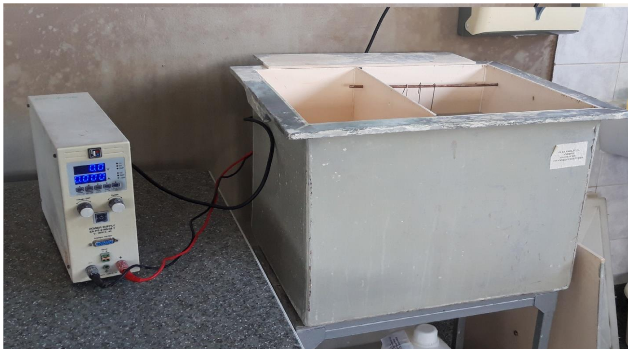
Slika 29. Ispravljač i kadica s elektrolitom [9]
