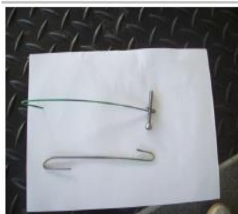
Slika 31. Držači proizvoda prilikom anodizacije [9]
