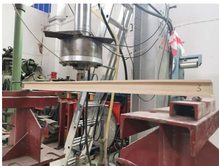
Slika 50. Priprema uzoraka za savojno ispitivanje.
