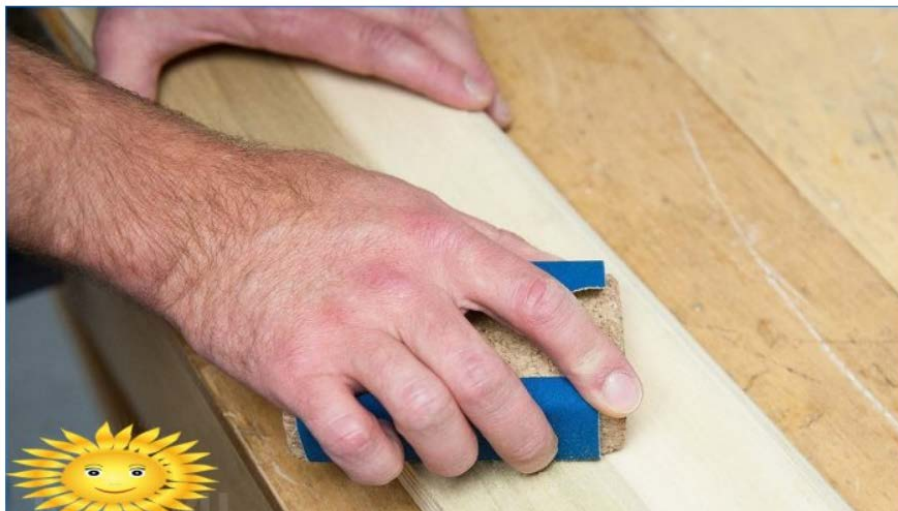
Slika 32. Priprema drvene površine brušenjem. [68]
