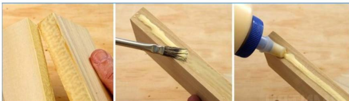
Slika 33. Nanošenje ljepila na drvo. [69]
