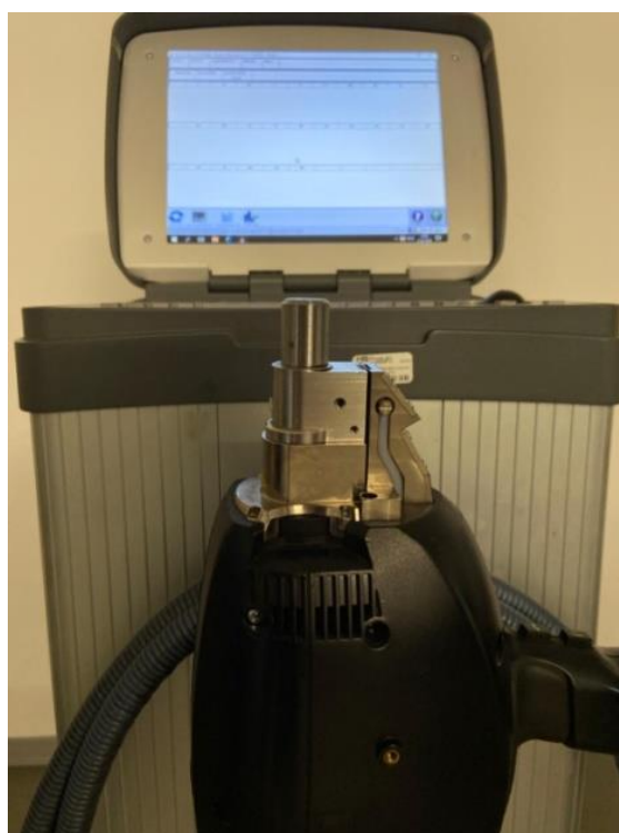
Slika 24. Ispitivanje kemijskog sastava na spektrometru [18]
