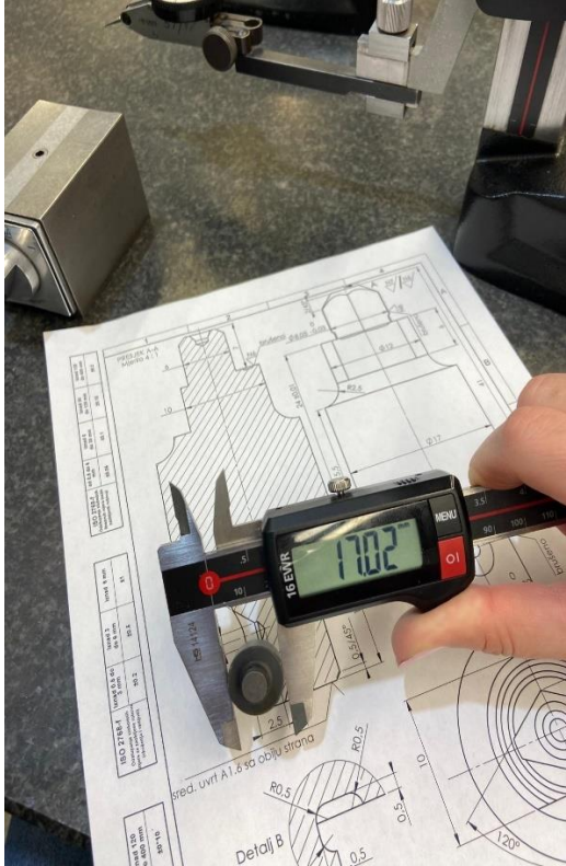
Slika 47. Mjerenje promjera obratka s pomičnim mjerilom [18] Slika 48. Mjerenje dužinske mjere obratka pomičnim mjerilom [18]
