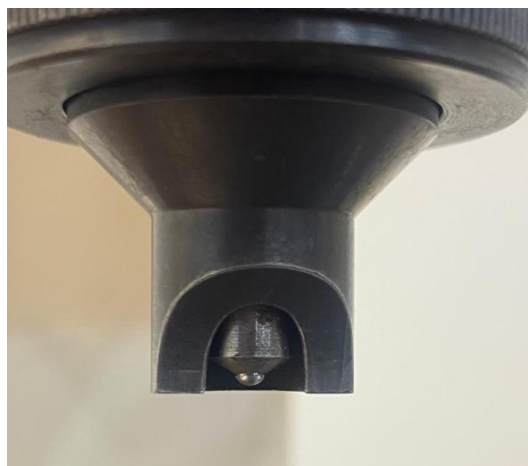
Slika 27. Penetrant u obliku kuglice – Brinell metoda [18]
