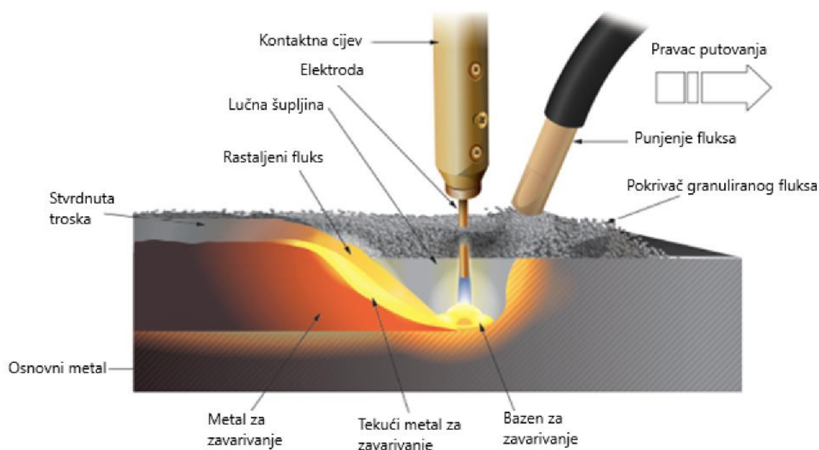
Slika 2. Shematski prikaz principa rada SAW zavarivanja [2]
