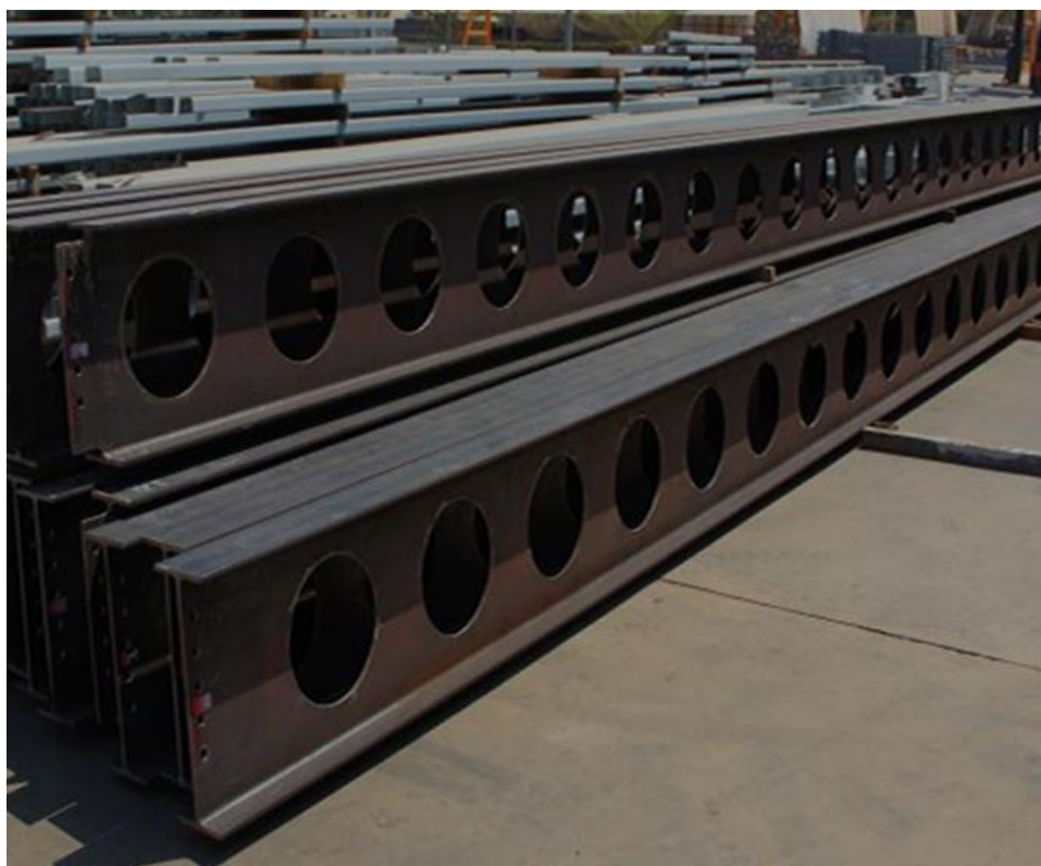
Slika 3. Specijalni I profil izrađen tehnologijom zavarivanja [4]
