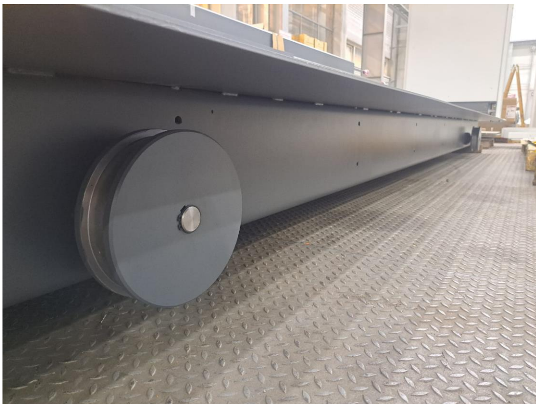
Slika 31. Pogonski kotači s vijencem na podvozju kolica
