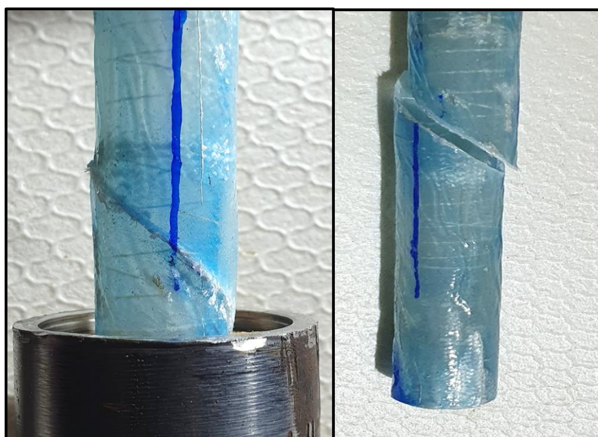
Slika 47. Oštećenje uzorka \pm 45^\circ nakon uvijanja
