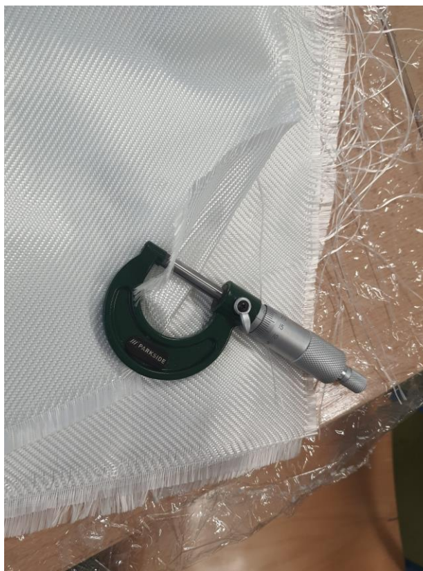
Slika 33. Mjerenje debljine tkanine mikrometrom
