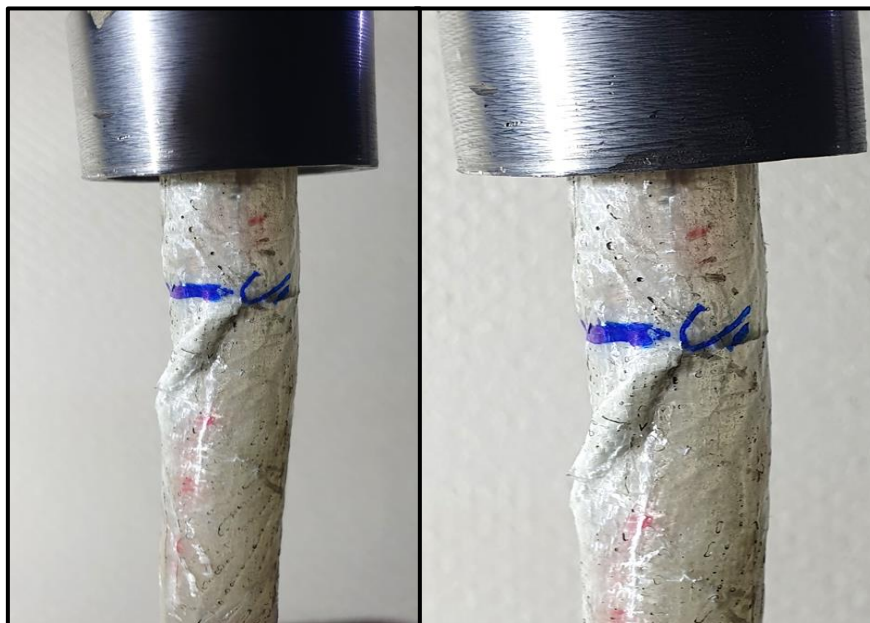
Slika 46. Oštećenje uzorka 0/90° nakon uvijanja
