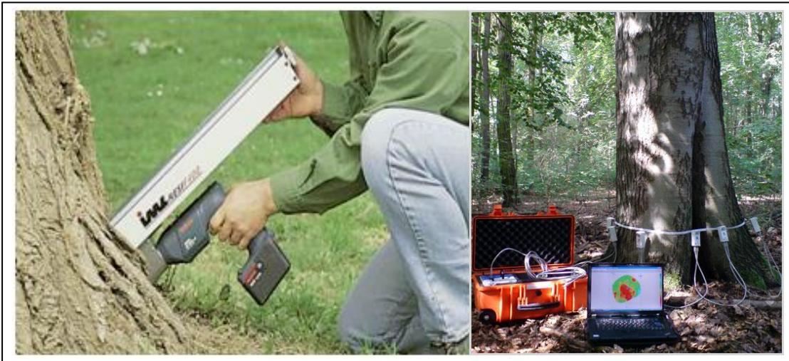
Slika br.17 Mjerenje rezistografiom i tomografom
