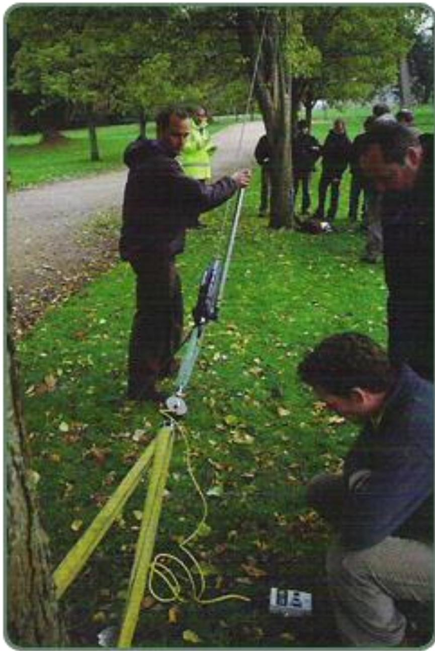
Slika br.19 Izvođenje poteznog testa
