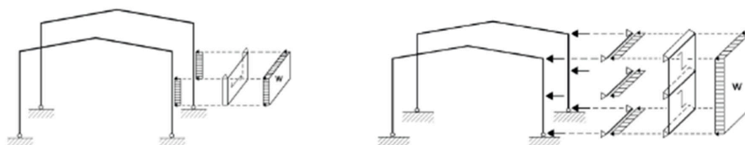
Slika 20. Prijenos horizontalnog opterećenja preko fasade direktno na stupove ili preko horizontalnih nosača fasade na stupove (desno) [11]
