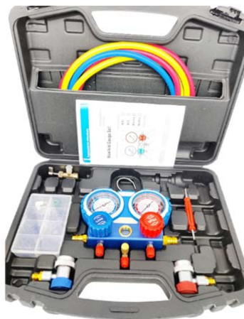
Slika 14. Dijagnostički alat za klima uređaje [14]
