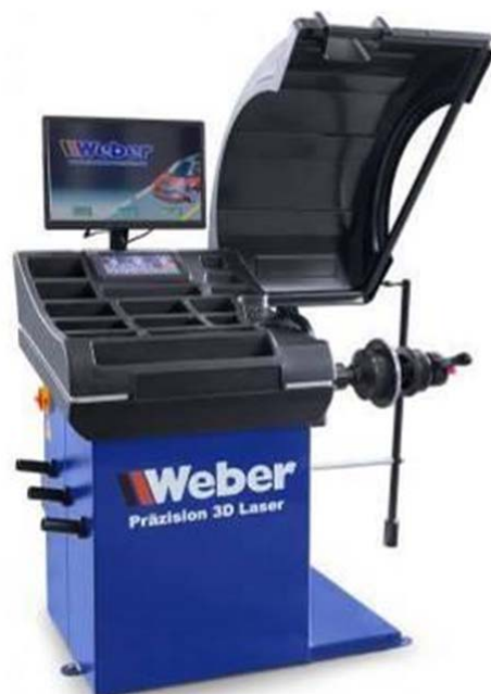
Slika 8. Stroj za balansiranje guma ("balansirka") [8]
