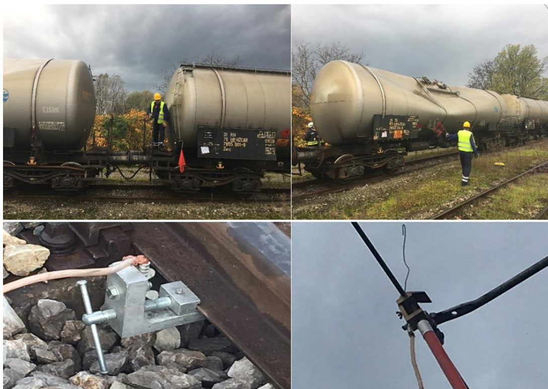
Slika 15 .Uzemljenje željezničkih vagona
