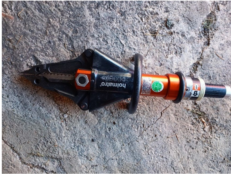
Slika 10. Kombinirani hidraulični alat [6]
