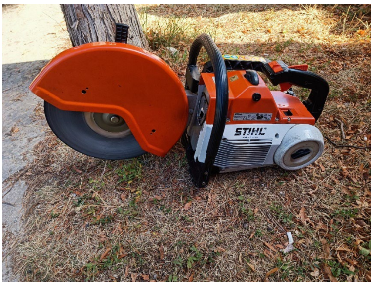
Slika 21. Motorna cirkulacijska pila [6]
