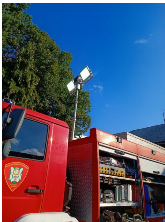
Slika 17. Stabilni reflektor na vozilu [6]
