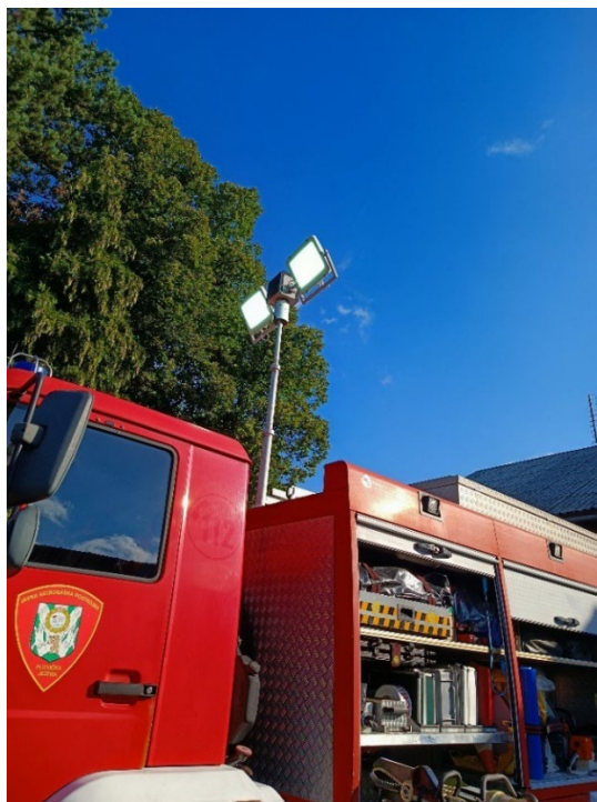
Slika 17. Stabilni reflektor na vozilu [6]
