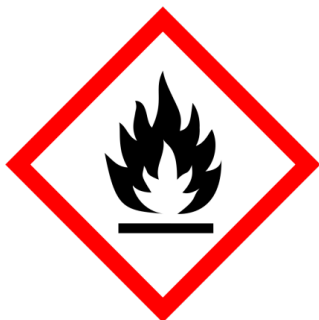
Slika 30. Piktogram opasnosti od zapaljivih i pirofornih tvari.
