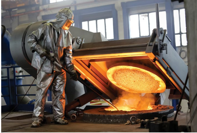
Slika 23. Dvodijelna odjeća za zaštitu radnika od povišene temperature i plamena.
