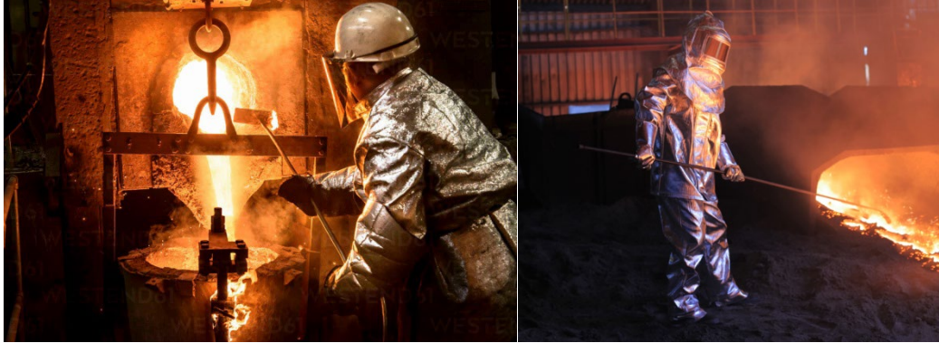
Slika 22. Osobna zaštitna odjeća za rad sa rastaljenim vrućim metalima.
