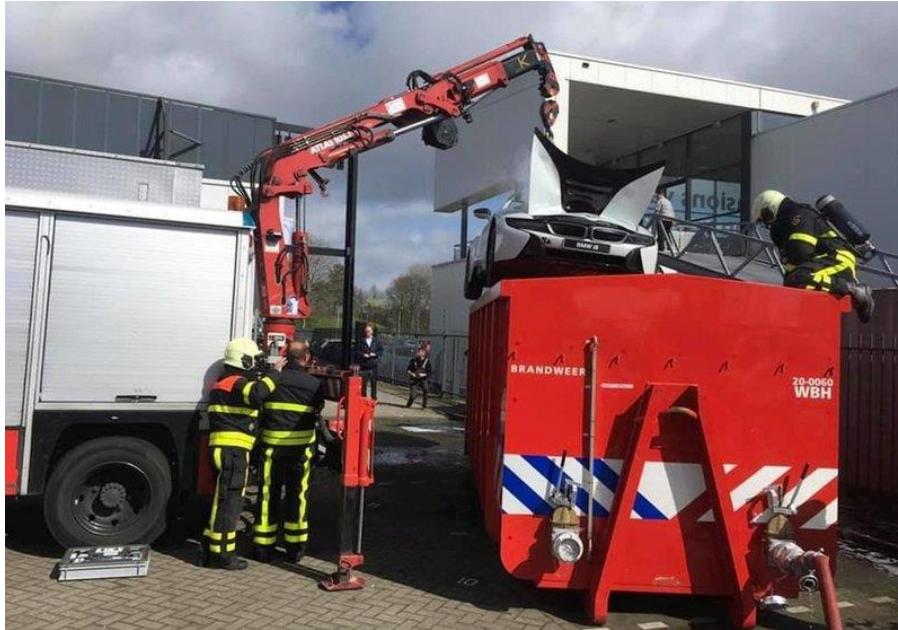
Slika 56. Uranjanje električnog vozila u Roll-of kontejner [19]
