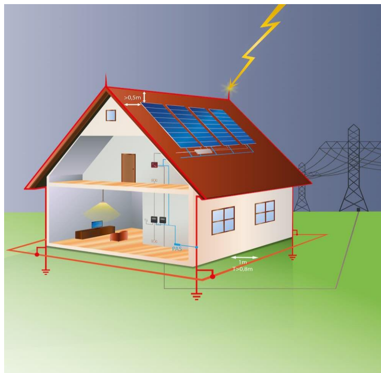
Slika 22. Princip zaštite od munje-groma na kući [9]
