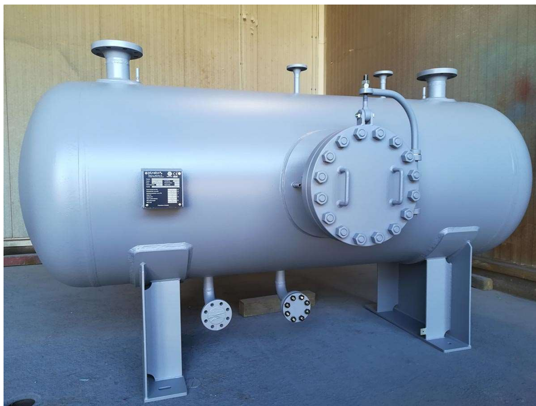
Slika 2. Horizontalni spremnik za vodu [17]
