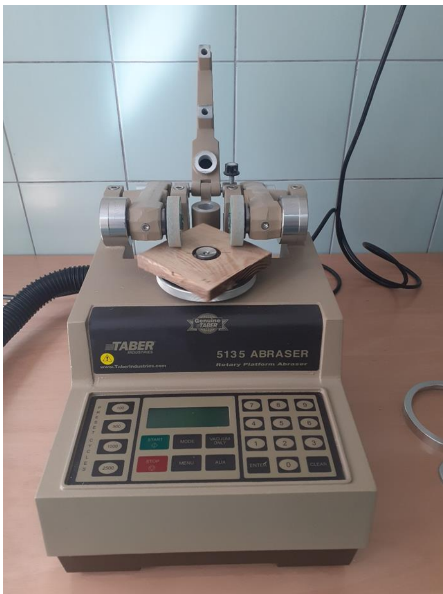
Slika 7 Taber test za procjenu otpornosti na habanje [izvorno autor]
