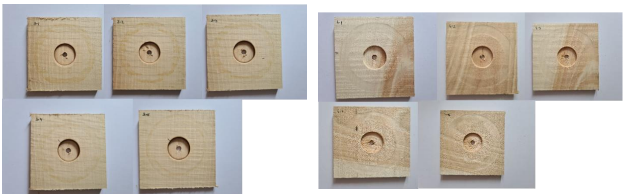
Slika 35 Uzorci oraha i topole nakon taber testa [izvorno autor]
