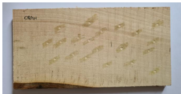
Slika 43 Uzorak oraha nakon ispitivanja pomoću Brinellove metode [izvorno autor]
