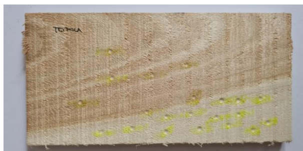
Slika 44 Uzorak topole nakon ispitivanja pomoću Brinellove metode [izvorno autor]
