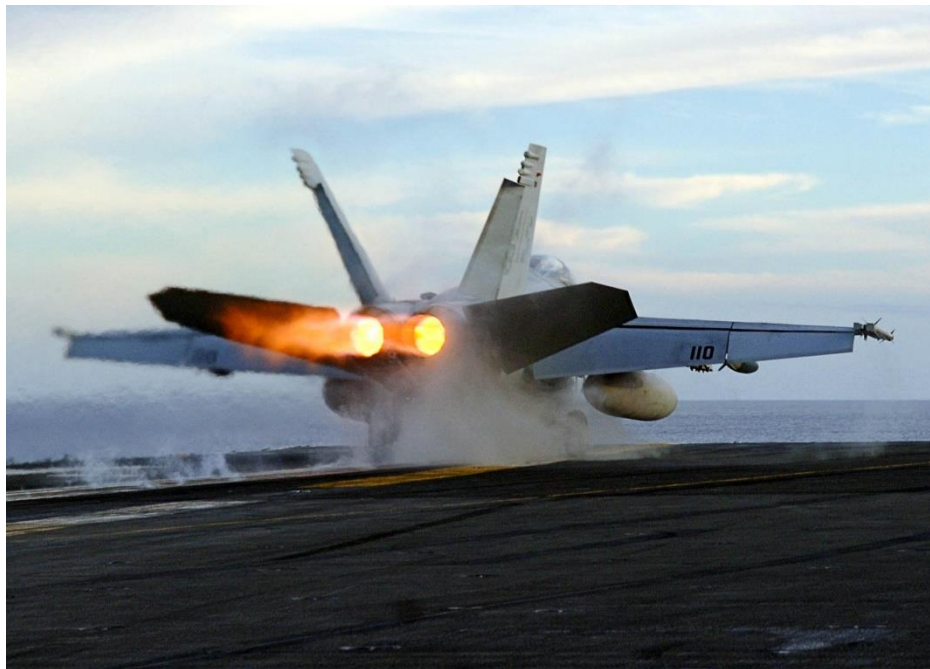
Slika 1. Katapultacija F18 prilikom korištenja nakladnog izgaranja [1]
