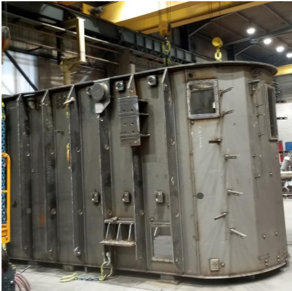
Slika 2. Transformatorski kotao (čelična konstrukcija)
