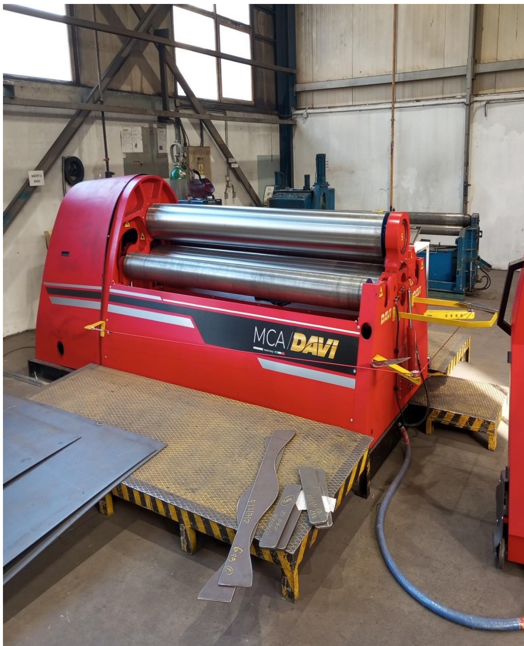
Slika 22. CNC stroj za kružno savijanje marke „Davi“
