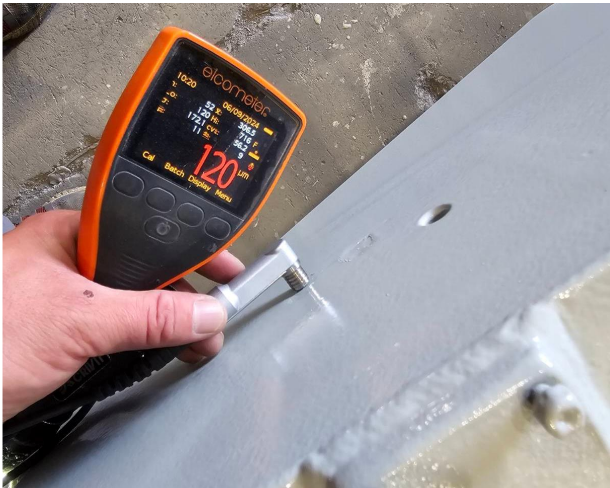
Slika 32. Mjerenje debljine boje Elcometrom
