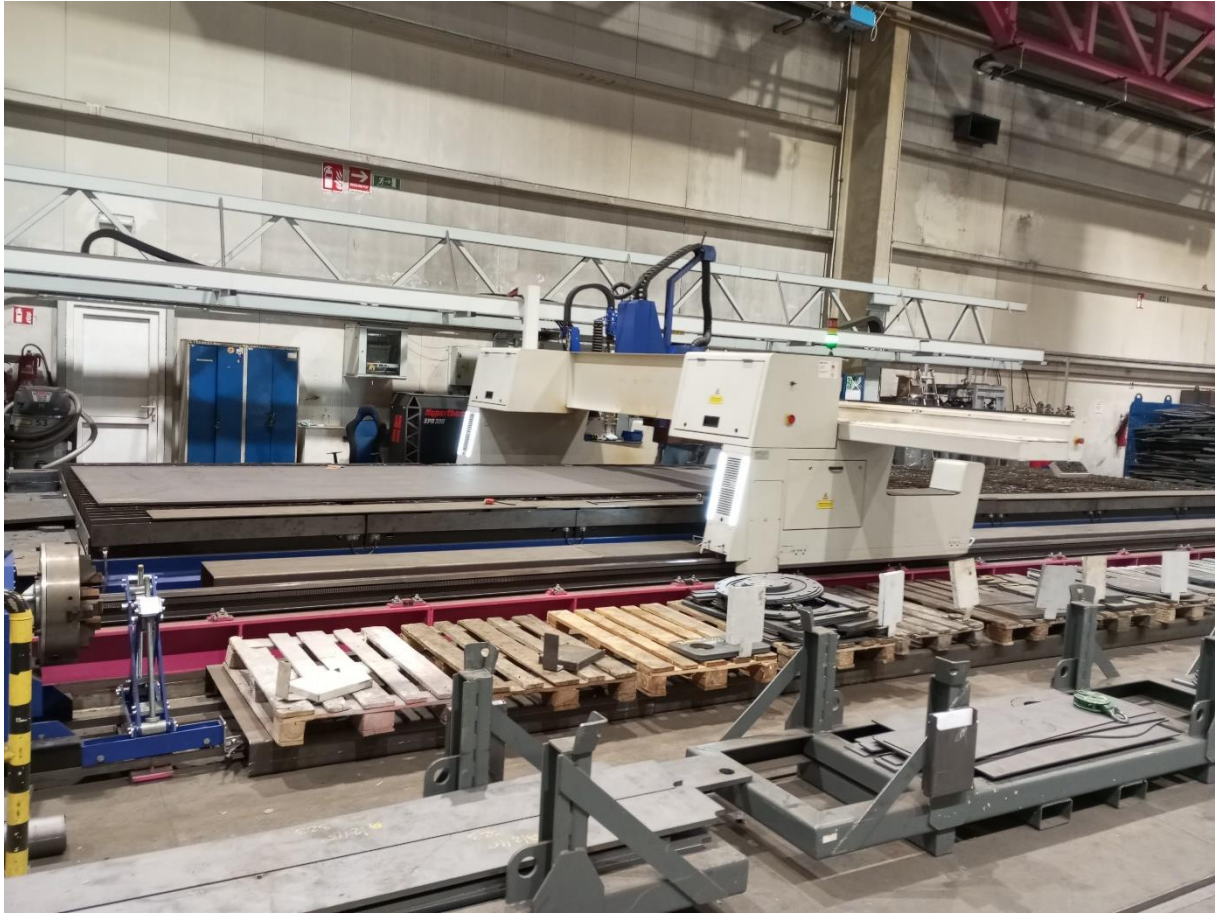
Slika 8. Stroj za plazma rezanje – „Eckert“
