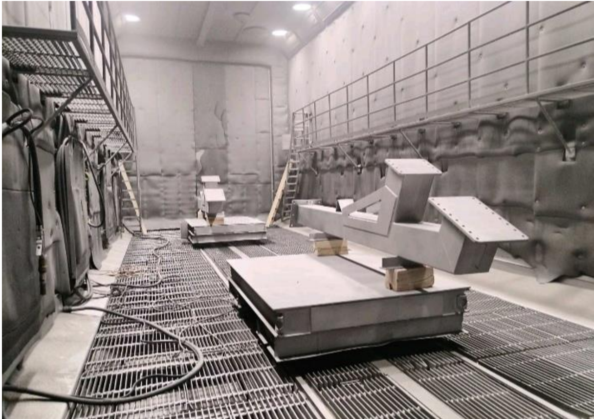
Slika 24. Komora za ručno sačmarenje
