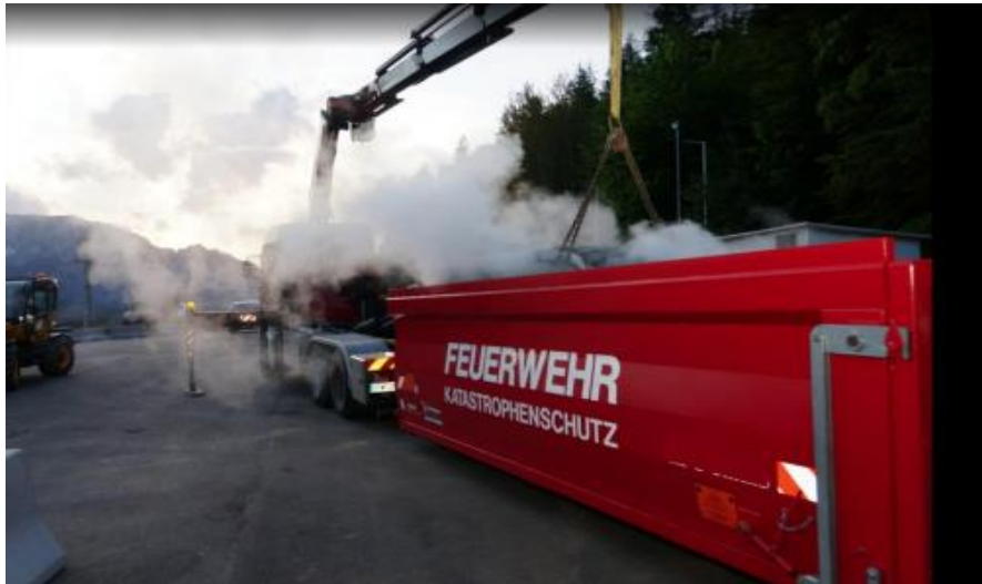
Slika 19. Namjenski kontejner za uranjanje električnog vozila u vodu [10]
