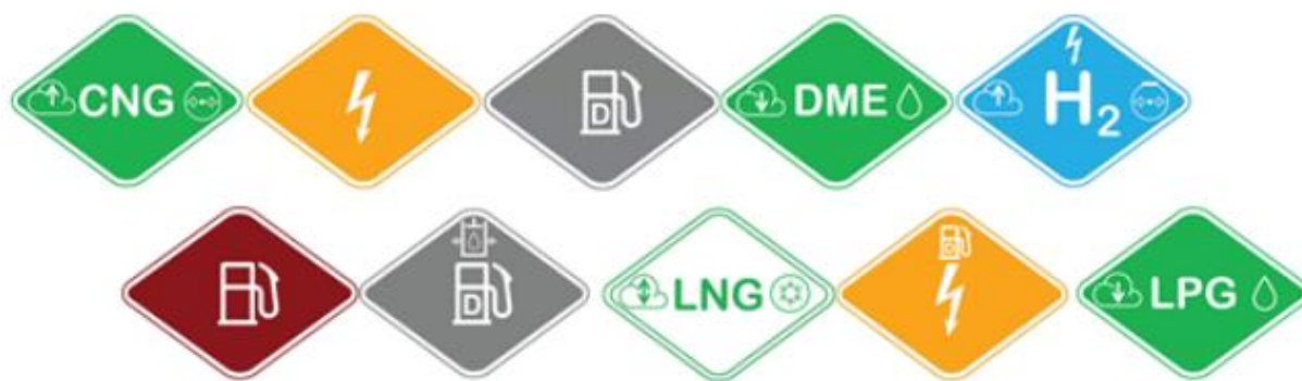
Slika 38. Označavanje pogonske energije vozila sukladno normi ISO 17840 [15]
