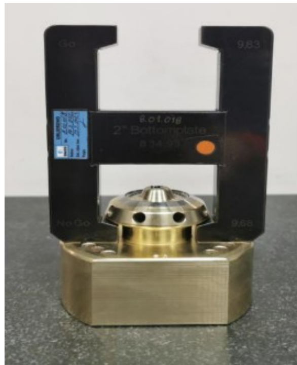
Slika 51. Postupak mjerenja kosine prizme na dnu kalupa [16]
