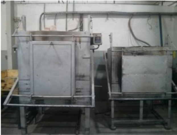
Slika 25. Električna peć i šamotna kutija [11]
