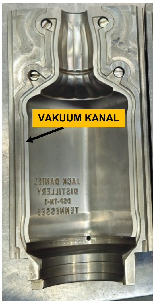
Slika 73. Prikaz M.P kalupa s lećastim zazorom
