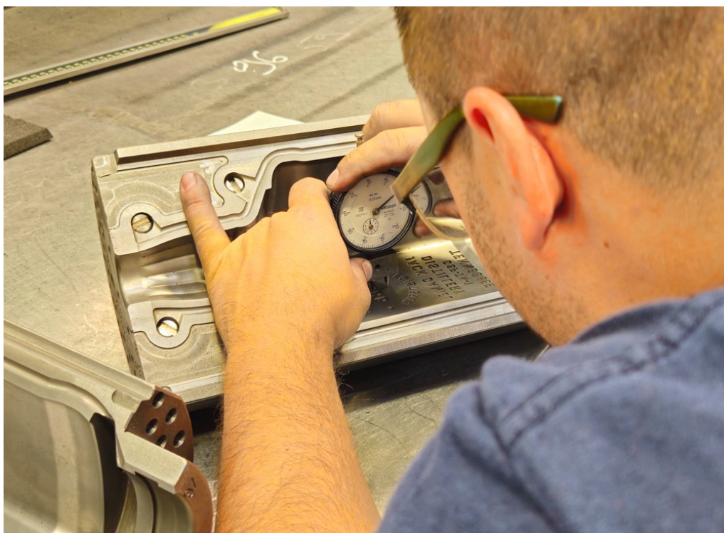
Slika 94. Mjerenje dubine gravure
