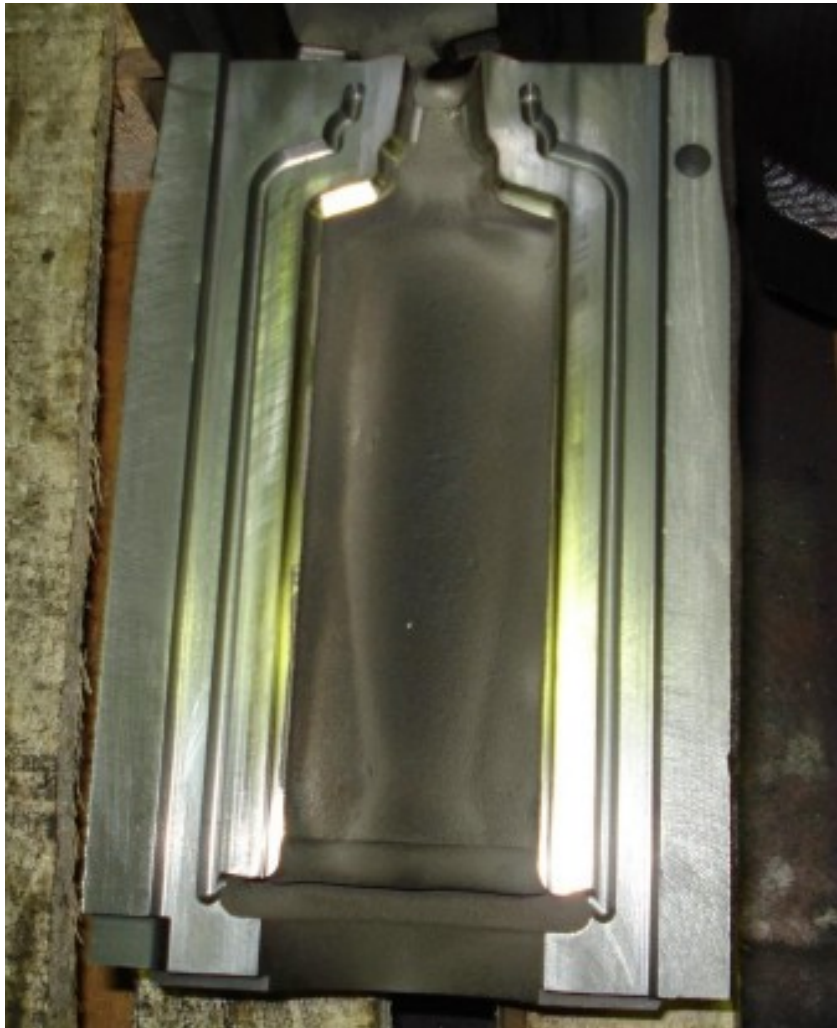
Slika 27. Glodanje po metalizaciji [11]
