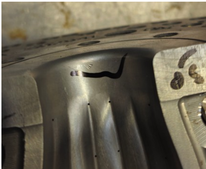
Slika 95. Oštećenje na grlu unutarnje stijenke
