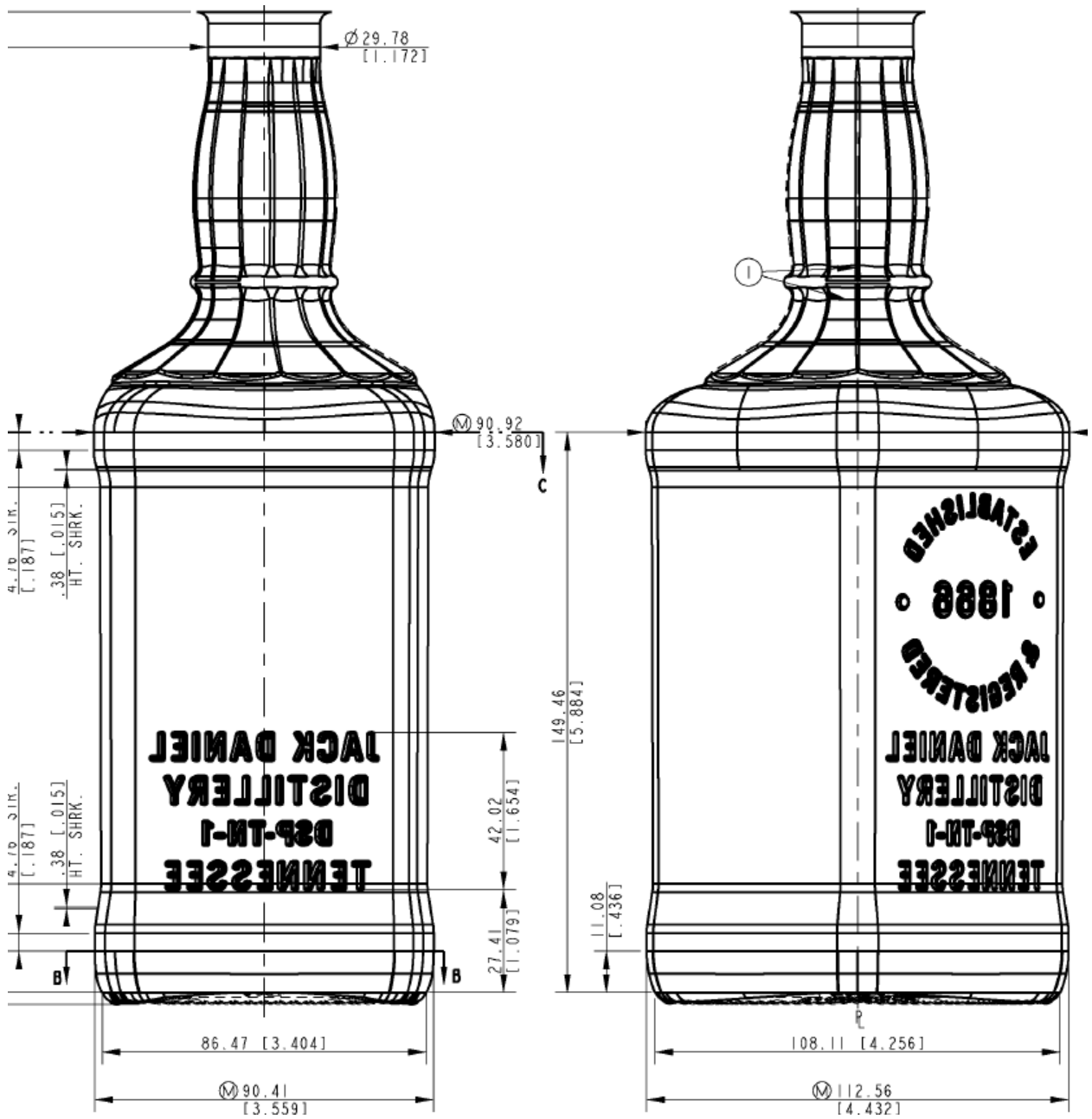
Slika 71. Mjere unutarnje stijenske kalupa na tehničkom crtežu
