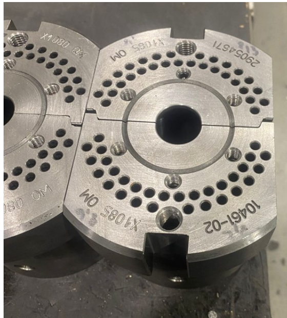
Slika 32. Vanjsko završno glodanje [11]
