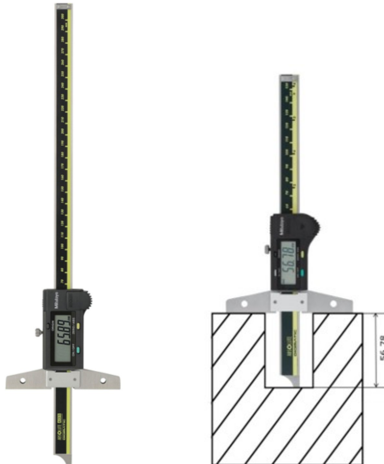
Slika 36. Dubinomjer i primjer mjerenja [12]
