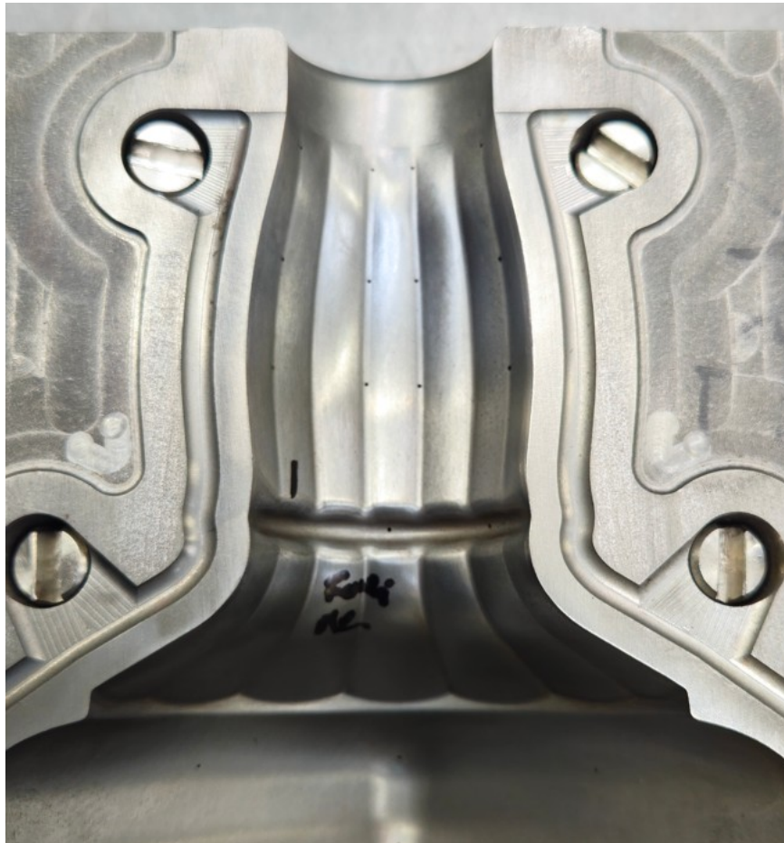
Slika 101. Nedostaje rupica za hlađenje na vratu unutarnje stijenke
